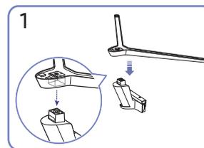
Inserire la base del piedistallo nel connettore seguendo la direzione indicata nella figura. Verificare che il connettore del piedistallo sia saldamente fissato.
