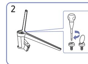
Ruotare completamente la vite di collegamento posta sul fondo del piedistallo in modo da fissarlo saldamente.
