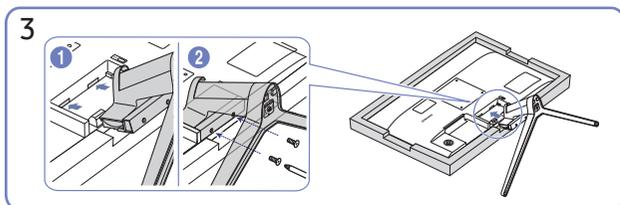
Collocare un panno morbido sul tavolo e appoggiarvi il prodotto con lo schermo rivolto verso il panno. Spingere il piedistallo assemblato nel corpo principale nella direzione indicata dalla freccia come mostrato in figura. Ruotare completamente la vite di collegamento posta sul fondo del corpo principale in modo da fissarlo saldamente.
