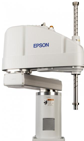
Un robot SCARA che offre un'eccezionale capacità di sollevamento di 10 kg, senza compromessi in termini di velocità o precisione.
