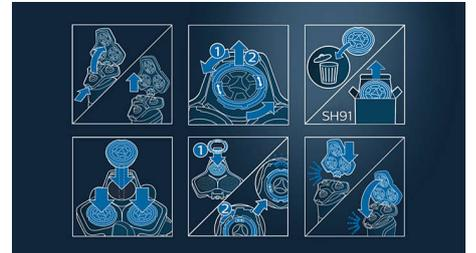
1. Drücken Sie die Entriegelungstasten und nehmen Sie den Scherkopf ab. 2. Drehen Sie die Ringe gegen den Uhrzeigersinn und entfernen Sie sie. 3. Entfernen Sie die alten Scherköpfe und setzen Sie die Ersatz-Scherköpfe ein (die Führungen sollten genau auf die Vorsprünge passen). 4. Setzen Sie die Ringe wieder auf und drehen Sie sie im Uhrzeigersinn, bis sie hörbar einrasten. 5. Setzen Sie den Scherhalter wieder ein und schließen Sie ihn.
