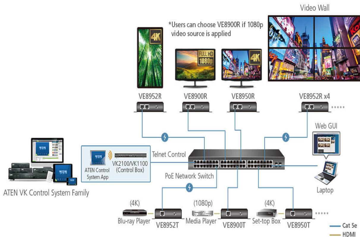
\*Nota: VE8952 supporta PoE e può essere installata insieme con gli switch di rete PoE per ridurre la cablaggio e le prese di alimentazione. Prima di scegliere lo switch di rete e l'installazione, consultare la Guida all'implementazione.
