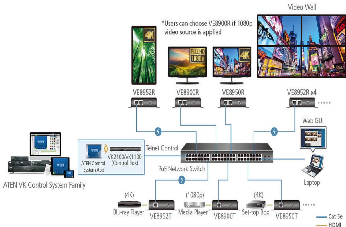
\*Nota: VE8952 admite PoE y se puede instalar en combinación con switches PoE para reducir los cables de alimentación y las tomas de corriente adicionales. Antes de elegir el switch de red y la instalación, consulte la Guía de implementación.
