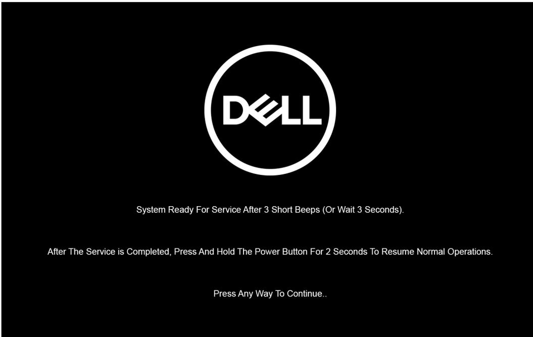
**i** **NOTA:** Si el adaptador de CA no se desconectó, aparecerá un mensaje en pantalla que le solicitará que quite el adaptador de CA. Quite el adaptador de CA y, a continuación, presione cualquier tecla para continuar con el procedimiento del **Modo de servicio**.
