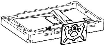
3. Lösen Sie die Montageschrauben, und trennen Sie dann die Halterung vom Monitor.
