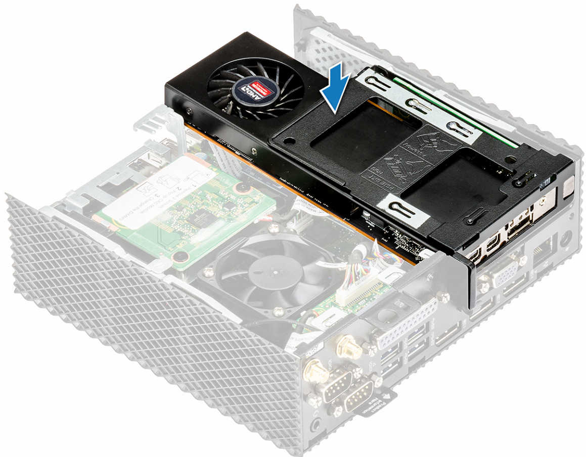
Figur 16. Tryck ned PCIe-modulen
