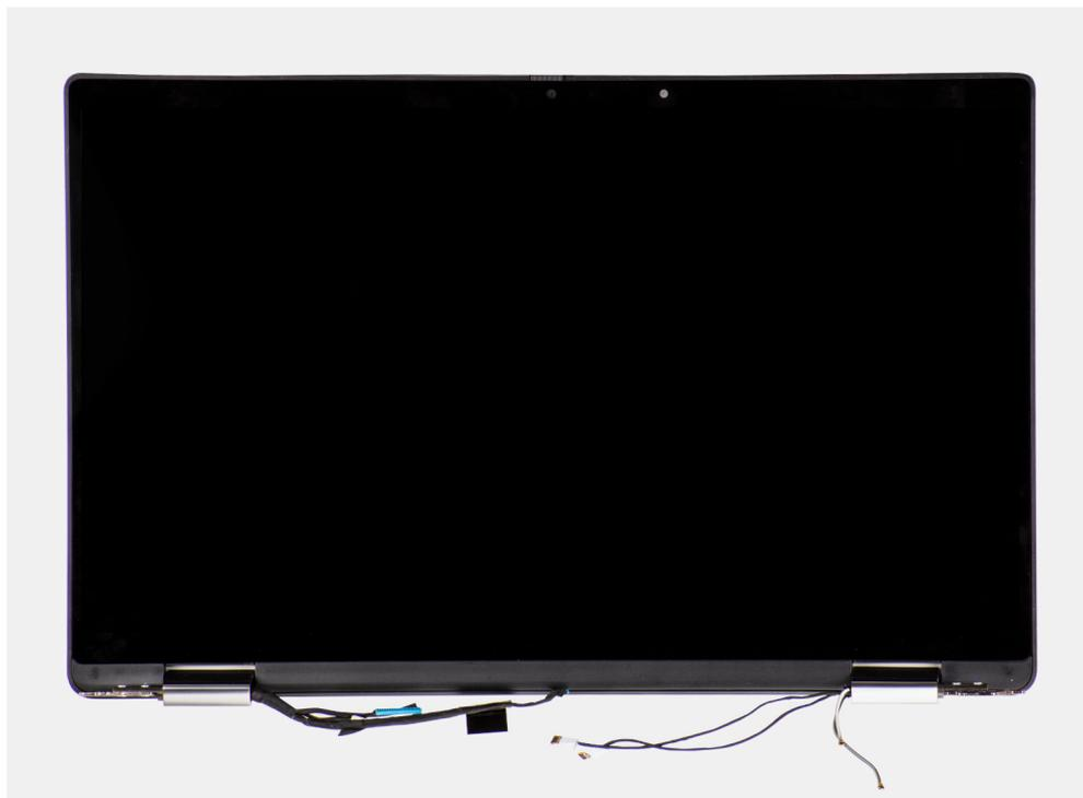
Figure 1. Assemblage d'écran avec câbles d'antenne
