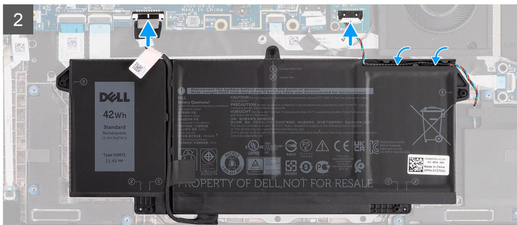
**REMARQUE :** Si la batterie est déconnectée de la carte système, le démarrage de l'ordinateur prend plus de temps, à cause de la réinitialisation de l'horloge temps réel (RTC).
