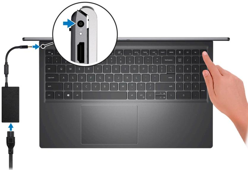
**NOTA:** Para conservar la energía de la batería, es posible que esta entre en el modo de ahorro de energía. Para encender el equipo, conecte el adaptador de alimentación y presione el botón de encendido.
