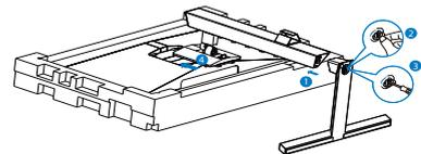
3. Richten Sie den Monitor nach Anbringung der Basis auf, indem Sie ihn mit beiden Händen sicher gemeinsam mit dem Styropor greifen. Nun können Sie das Styropor herausziehen. Drücken Sie den Bildschirm beim Herausziehen des Styropors nicht zusammen. Andernfalls könnte er beschädigt werden.
