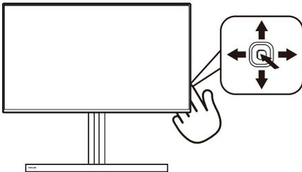
Um auf das OSD-Menü auf diesem Philips-Bildschirm zuzugreifen, verwenden Sie einfach die Umschalttaste auf der Rückseite des Bildschirms. Diese Taste funktioniert wie ein Joystick. Um den Cursor zu bewegen, bewegen Sie die Taste in vier Richtungen. Drücken Sie die Taste, um die gewünschte Option zu wählen.
