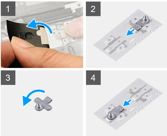
En la imagen a continuación, se proporciona una representación visual del procedimiento para instalar el soporte de montaje para unidad de estado sólido, al reemplazar la unidad de estado sólido M.2 2280 con una unidad de estado sólido M.2 2230 en la ranura M.2 uno.
