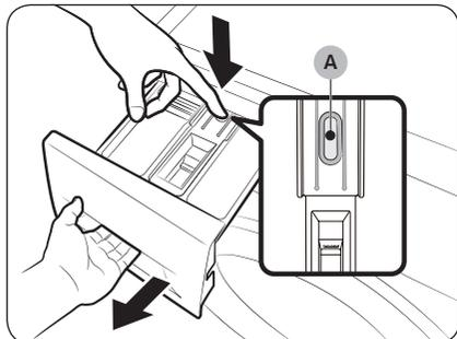
1. Mientras sujeta la **palanca de desbloqueo (A)** del interior de la cubeta, deslice la cubeta para abrirla.
