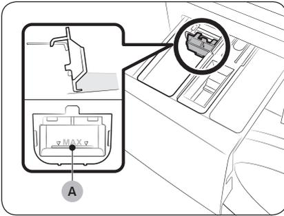
En primer lugar inserte el contenedor para líquido en el **compartimento del lavado principal**. Luego ponga detergente líquido en el contenedor por debajo de la **línea máxima (A)** marcada.
