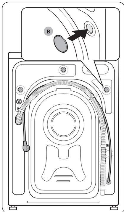
3. Inserte los **taponos de los tornillos (B)** en los agujeros (marcados con un círculo en la imagen).
