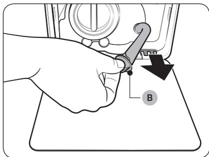
3. Ponga un recipiente grande y vacío alrededor de la tapa y extienda el tubo de desagüe de emergencia hacia el recipiente mientras sujeta el **tapón del tubo (B)**.
