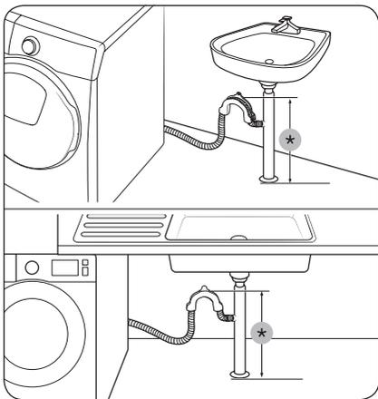
**En un ramal de la tubería de desagüe del lavabo**
