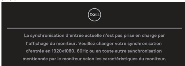
Cela signifie que l'écran ne peut pas se synchroniser avec le signal reçu depuis l'ordinateur. Voir [Spécifications du moniteur](#) pour connaître les limites des fréquences Horizontales et Verticales acceptables par ce moniteur. Le mode recommandé est **1920 x 1080**.
