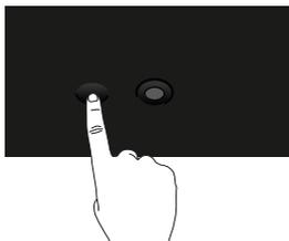
Pour accéder au menu de verrouillage, appuyez et maintenez le bouton de navigation Haut ou Bas ou Gauche ou Droite enfoncé pendant quatre secondes. Un menu de verrouillage apparaît dans le coin inférieur droit de l'écran.
