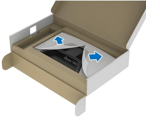
**HINWEIS:** Stellen Sie vor dem Anbringen des Ständers am Monitor sicher, dass die Frontplattenklappe geöffnet ist, um Platz für die Montage zu schaffen.
