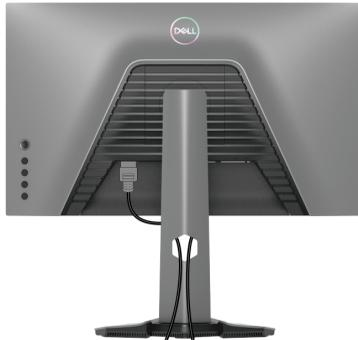
Nachdem Sie sämtliche erforderlichen Kabelverbindungen an Monitor und Computer hergestellt haben (siehe [Monitor anschließen](#)), führen Sie die Kabel wie oben gezeigt ordentlich durch den Kabelschacht.
