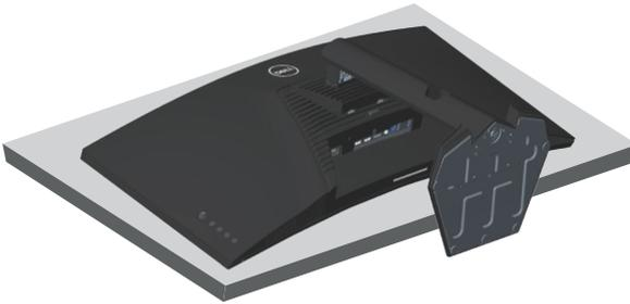
2. Appuyez et maintenez le bouton de déverrouillage du socle enfoncé, puis soulevez le socle pour le retirer du moniteur.
