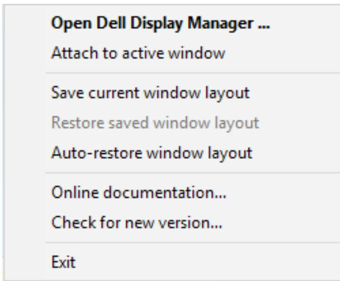
Se você escolher "**Auto-restore window layout (Layout da janela de restauração automática)**", posições de suas janelas aplicativo são controladas e lembradas pelas DDM. DDM automaticamente coloca as janelas de aplicação em suas posições originais quando você se reconectar o seu PC ao seu monitor(es).
