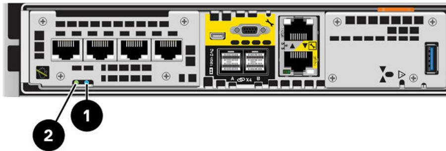
Abbildung 83. Storage-Prozessorbaugruppe-LEDs
