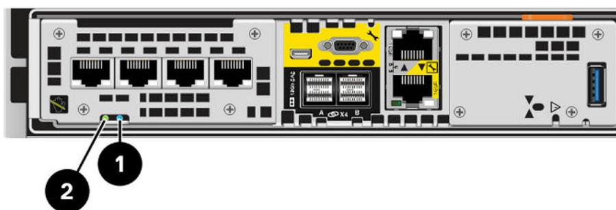
Abbildung 7. Storage-Prozessorbaugruppe-LEDs
