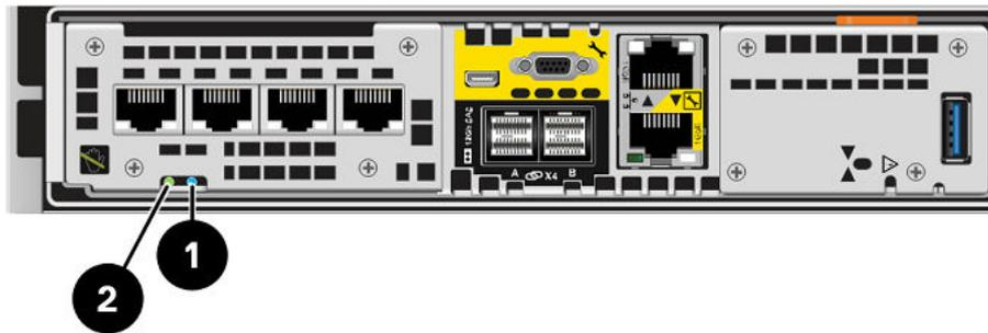
Abbildung 70. Storage-Prozessorbaugruppe-LEDs
