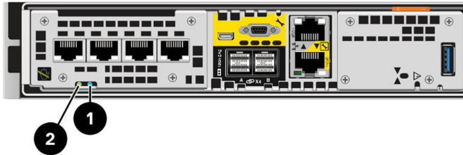
Abbildung 95. Storage-Prozessorbaugruppe-LEDs
