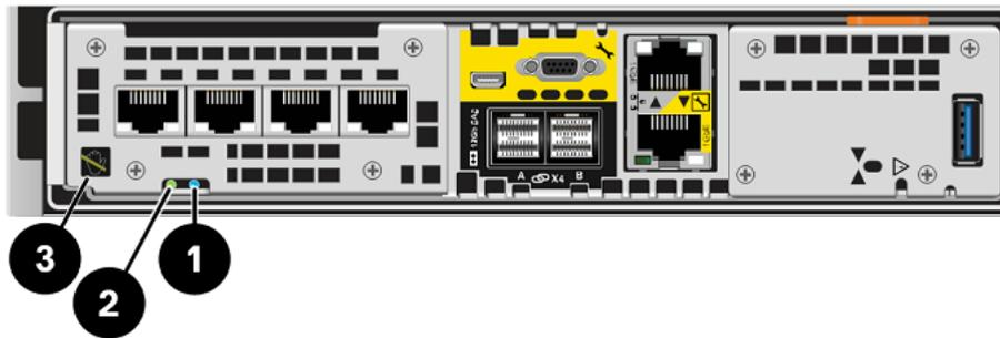
Abbildung 12. SP-Fehler- und Betriebs-LEDs
