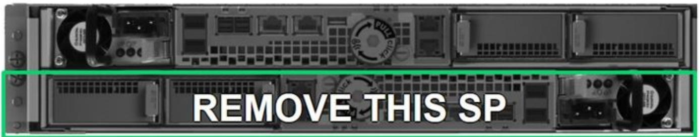
Abbildung 25. Entfernen einer SP-Baugruppe – Beispiel
