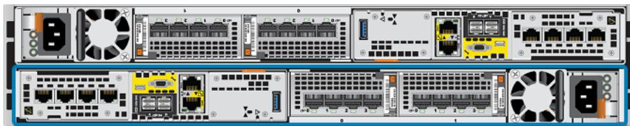
Abbildung 50. Position des funktionierenden Storage-Prozessors A - Beispiel
