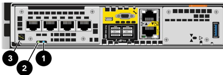
Abbildung 22. SP-Fehler- und Betriebs-LEDs
