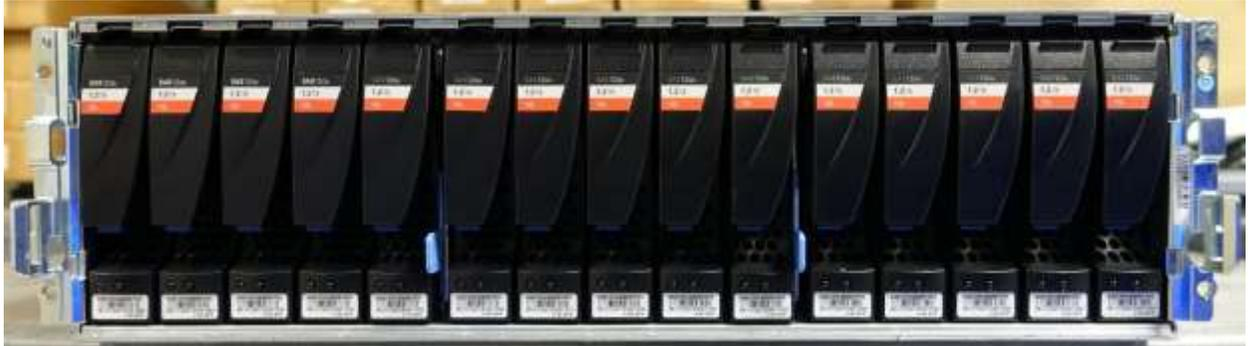
Figure 25. Boîtier DAE 3U 15 disques de 3,5 pouces (avant)
