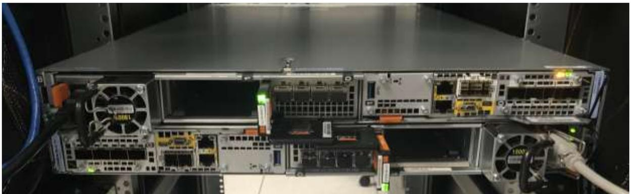
Figure 11. Arrière du boîtier DPE (480/F, 680/F, 880/F)
