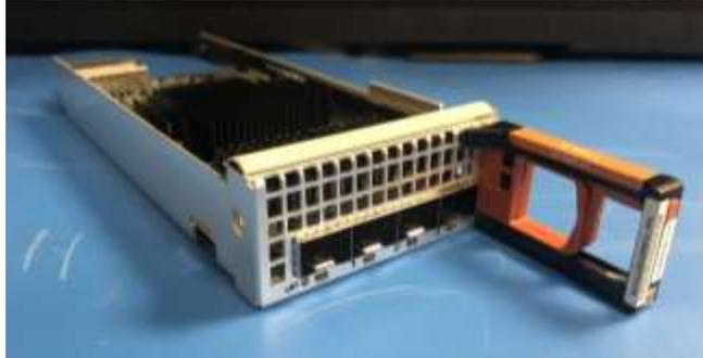
Figure 22. Module d'E/S optique 25GbE
