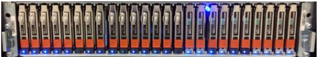
Figure 2. Boîtier DPE 2U 25 disques (380/F)
