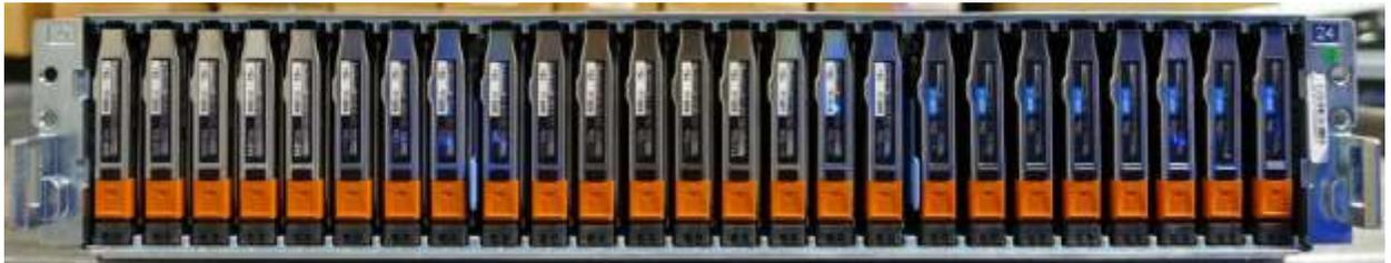
Figure 23. Boîtier DAE 2U 25 disques de 2,5 pouces (avant)
