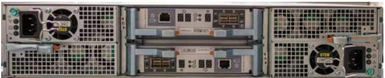
Figure 24. Boîtier DAE 2U 25 disques de 2,5 pouces (arrière)
