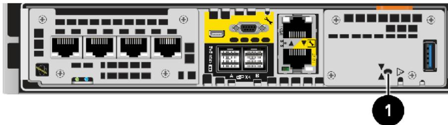
**Abbildung 8. Position der NMI-Taste auf dem embedded module**
