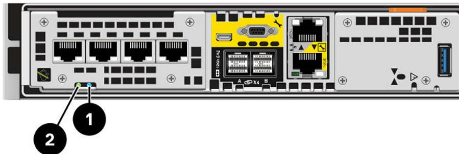
Figure 7. LED du Ensemble de processeurs de stockage
