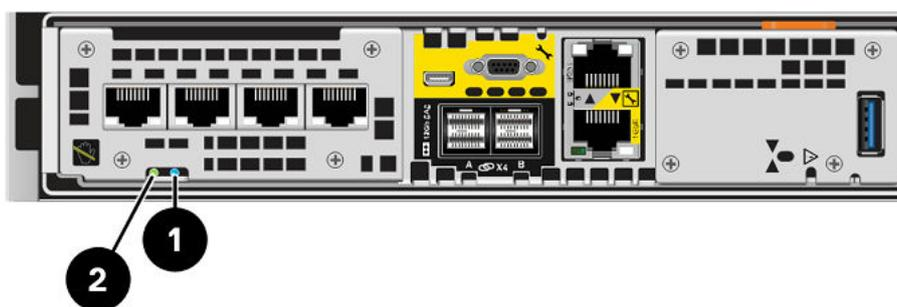
Abbildung 7. Storage-Prozessorbaugruppe-LEDs
