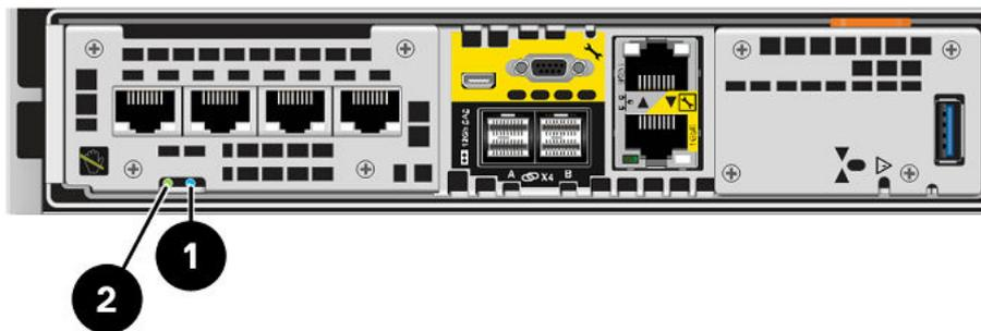
Abbildung 109. Storage-Prozessorbaugruppe-LEDs
