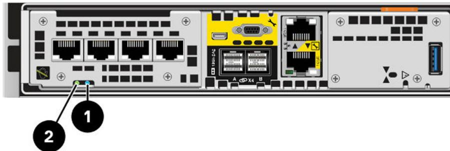
Abbildung 83. Storage-Prozessorbaugruppe-LEDs
