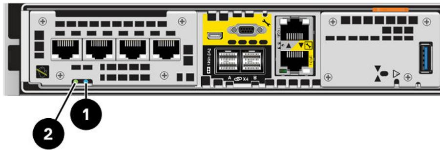
Abbildung 70. Storage-Prozessorbaugruppe-LEDs
