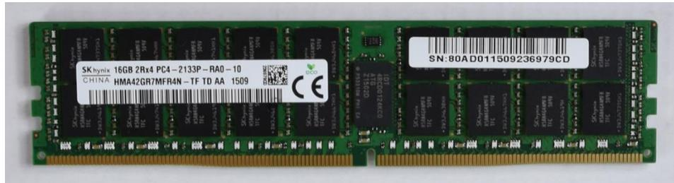
Abbildung 8. Dual-Inline Memory Module (DIMM) (380/F)
