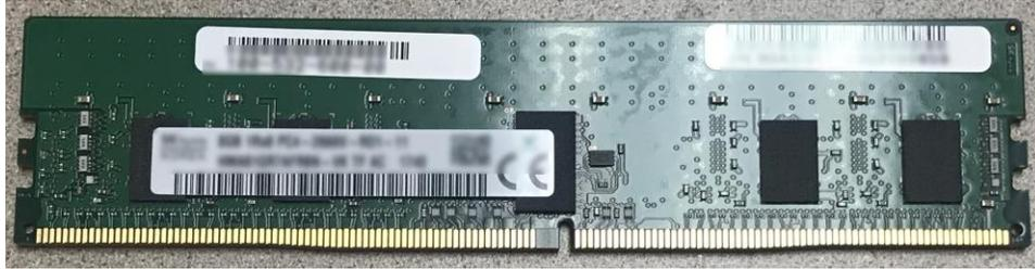
Abbildung 17. Dual-Inline Memory Module (DIMM) (480/F, 680/F, 880/F)
