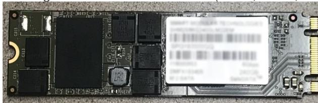
Abbildung 13. M.2-SATA-SSD-Gerät (480/F, 680/F, 880/F)
