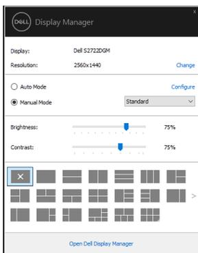
La boîte de dialogue **Réglages rapides** permet également d'accéder à l'interface utilisateur avancée de Dell Display Manager qui sert à régler les fonctions de base, configurer le mode automatique et accéder à d'autres fonctions.
