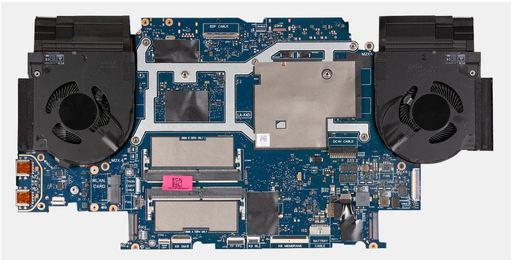
18. Drehen Sie die Systemplatine um und entfernen Sie die USB-Platine und den Kühlkörper.
