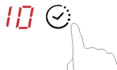
Impostare il tempo toccando il comando "-" o "+" del timer. Suggerimento: toccare il comando "-" o "+" del timer una sola volta per ridurre o aumentare il tempo con incrementi di 1 minuto.
