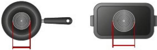
5. Se la parte ferromagnetica copre solo parzialmente la base della pentola, si riscalda solo l'area ferromagnetica e il resto della base potrebbe non raggiungere la temperatura sufficiente per la cottura.
