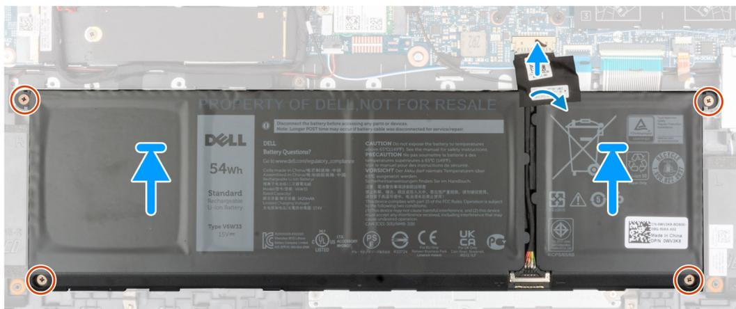
1. Utilizando os postes de alinhamento, coloque a bateria de 4 células no conjunto do teclado e descanso para os pulsos.
