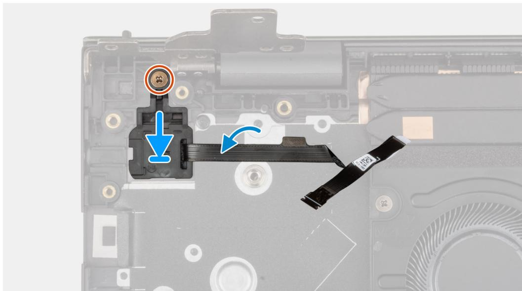
1. Alinhe e coloque o botão de alimentação com leitor de impressões digitais opcional no conjunto do teclado e descanso para os pulsos.
