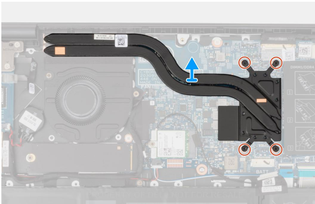
1. Pela ordem inversa sequencial (como indicado no dissipador de calor), desaperte os quatro parafusos integrados que fixam o dissipador de calor à placa de sistema.
