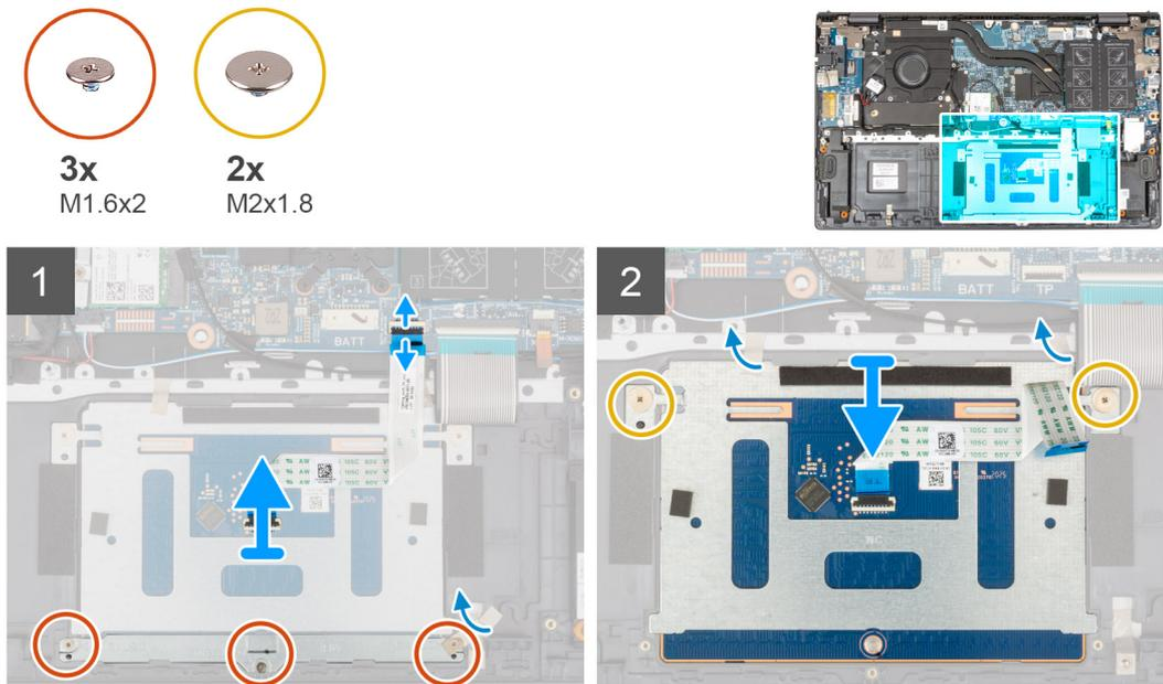
1. Abra o trinco e desligue o cabo do painel tátil da placa de sistema.
