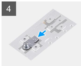
A imagem a seguir fornece uma representação visual do procedimento de instalação do suporte de montagem do disco de estado sólido quando volta a colocar um disco de estado sólido M.2 2280 com um disco de estado sólido M.2 2230 na primeira ranhura M.2.
