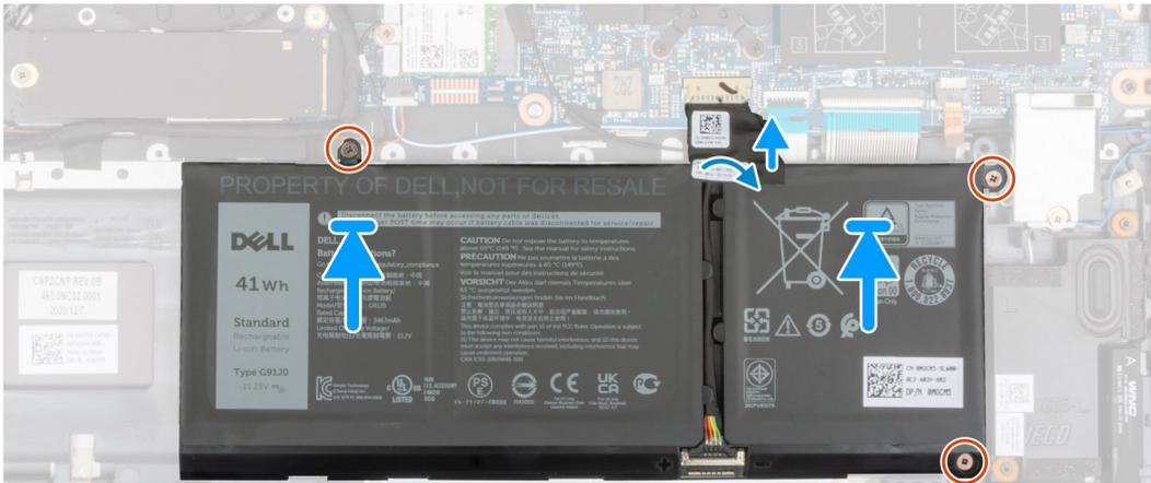
1. Utilizando os postes de alinhamento, coloque a bateria de 3 células no conjunto do teclado e descanso para os pulsos.
