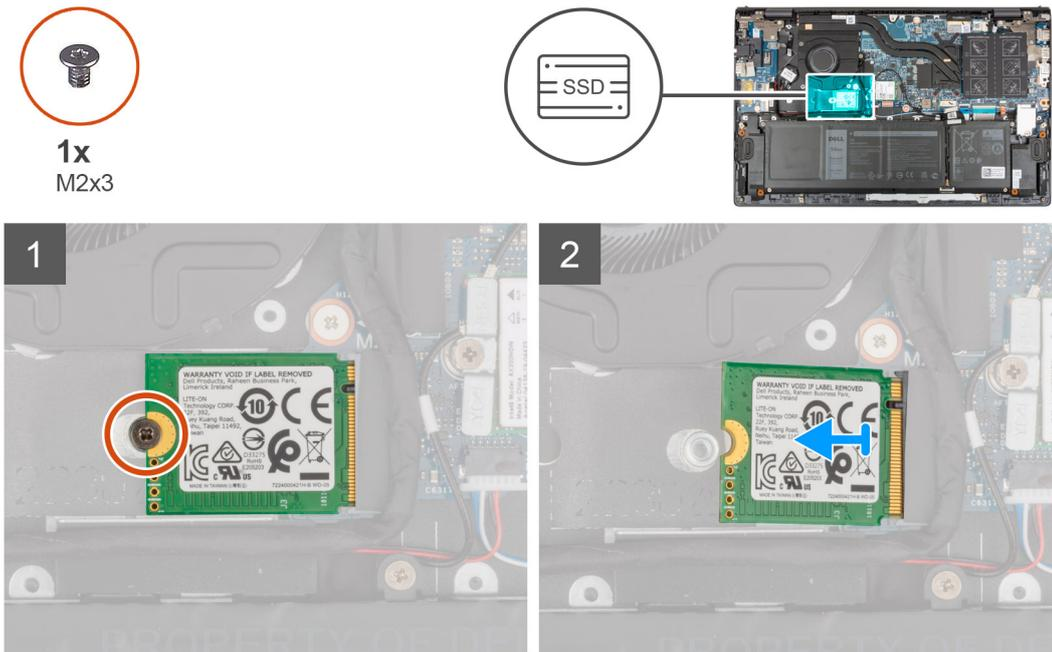
1. Retire o parafuso (M2x3) que fixa o disco de estado sólido 2230 ao conjunto do teclado e descanso para os pulsos.
