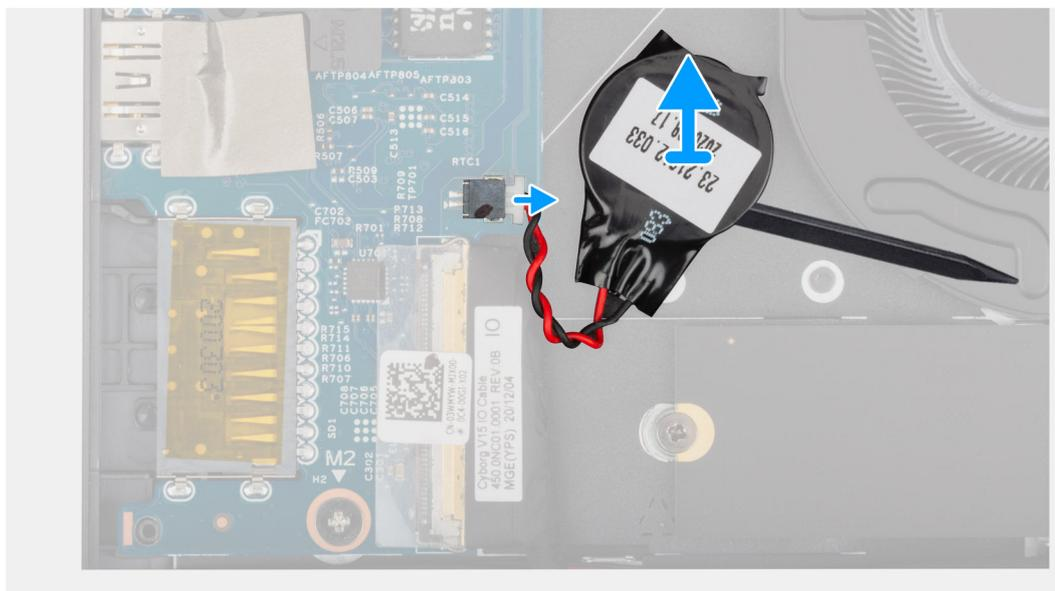
1. Desligue o cabo da bateria de célula tipo moeda da placa de E/S.
