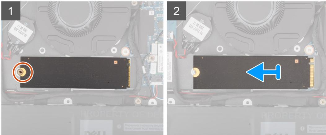
1. Retire o parafuso (M2x3) que fixa o disco de estado sólido ao conjunto do teclado e descanso para os pulsos.
