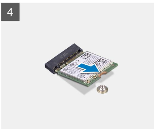
1. Volte a colocar o parafuso (M2x3) que fixa o suporte da placa sem fios à própria placa e à placa de sistema.
