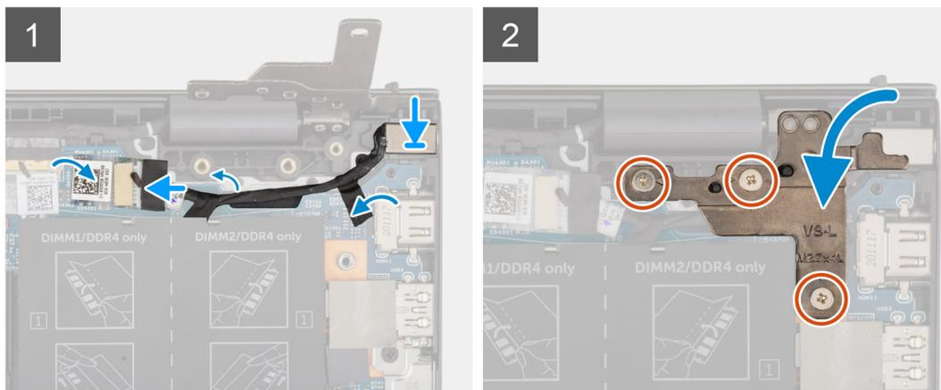
1. Coloque a porta do transformador e o respetivo cabo dentro da ranhura no conjunto do teclado e descanso para os pulsos.
