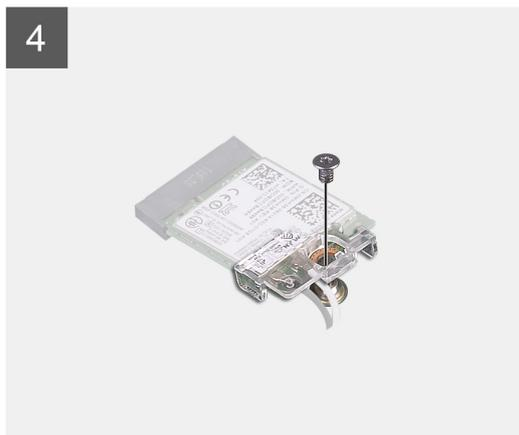
1. Ligue os cabos da antena à placa sem fios.
