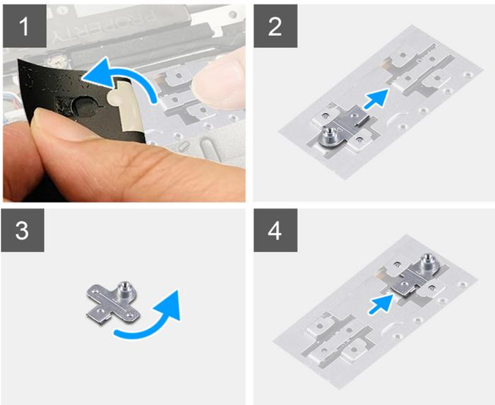
1. Deslize e retire o suporte de montagem do disco de estado sólido da ranhura do suporte de montagem no conjunto do teclado e descanso para os pulsos.
