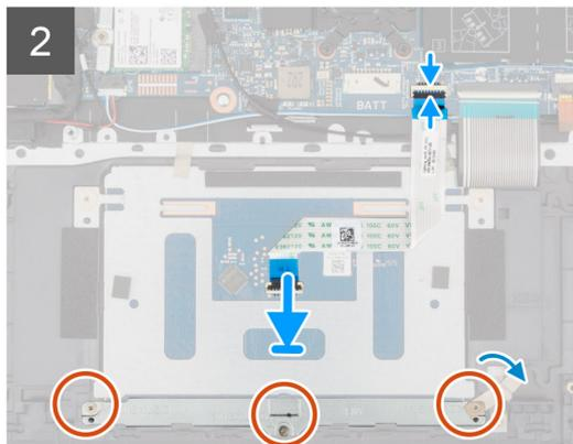
1. Deslize o painel tátil para dentro da ranhura no conjunto do teclado e descanso para os pulsos.
