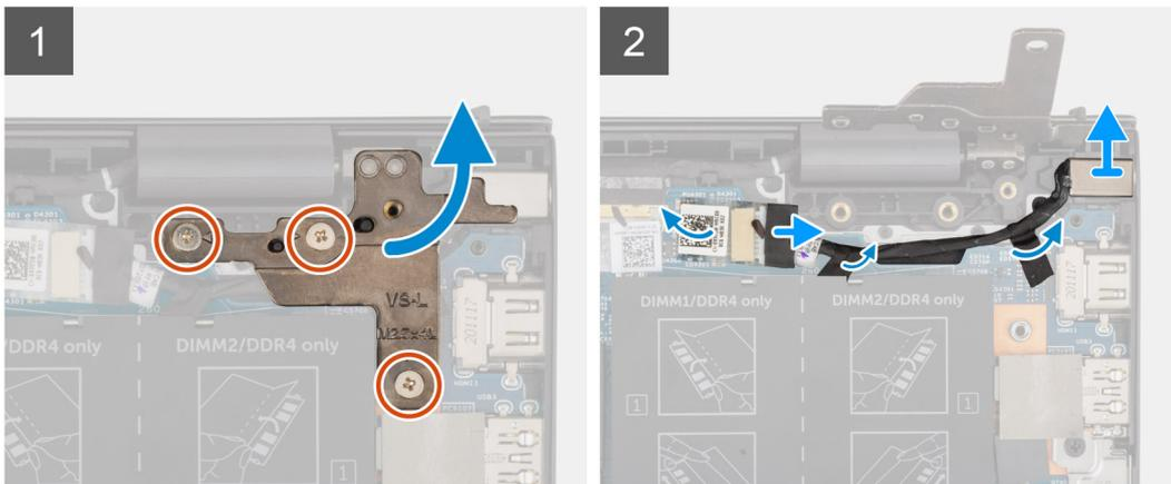
1. Retire os três parafusos (M2.5x4.5) que fixam a dobradiça direita do ecrã à placa de sistema.
