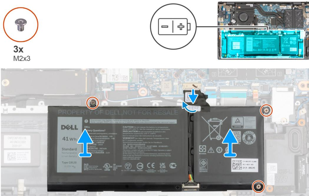
1. Descole a fita adesiva que fixa o cabo da bateria à placa de sistema.
