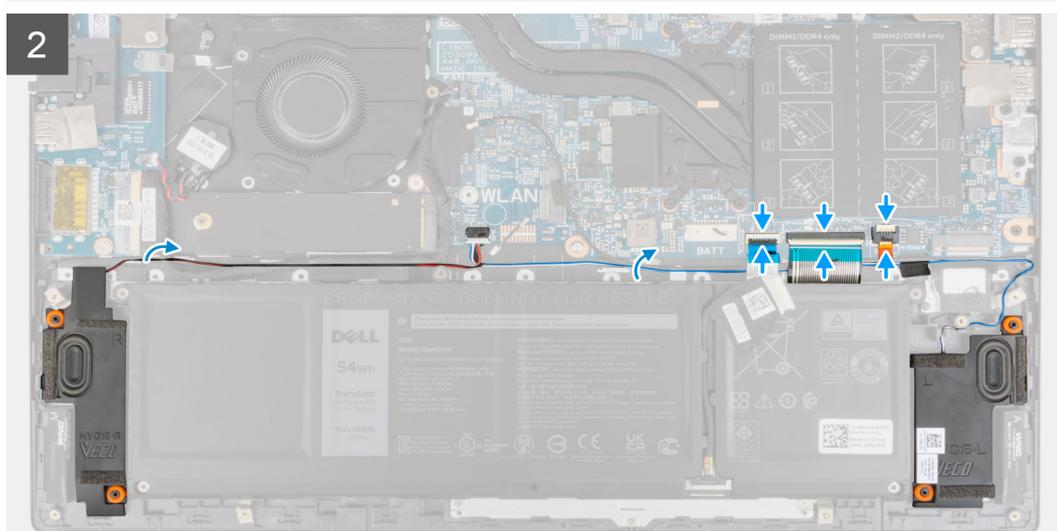
1. Utilizando os postes de alinhamento e as ilhoses de borracha, coloque as colunas nas ranhuras no conjunto do teclado e descanso para os pulsos.
