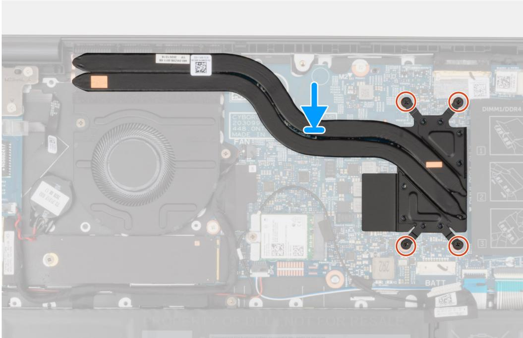
1. Alinhe os orifícios dos parafusos no dissipador de calor com os orifícios dos parafusos na placa de sistema.
