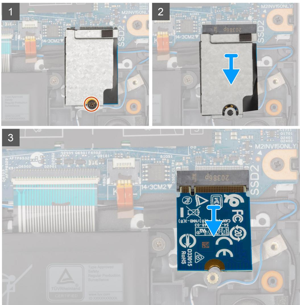
1. Retire o parafuso (M2x3) que fixa o disco de estado sólido e a respetiva blindagem térmica ao conjunto do teclado e descanso para os pulsos.
