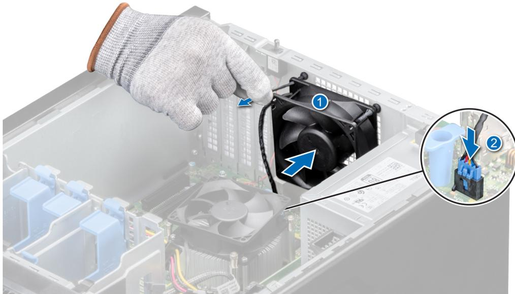
Figure 27. Installing a cooling fan
