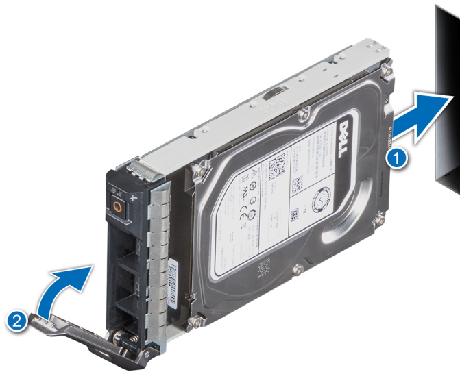
Ilustración 31. Instalación de un portaunidades
