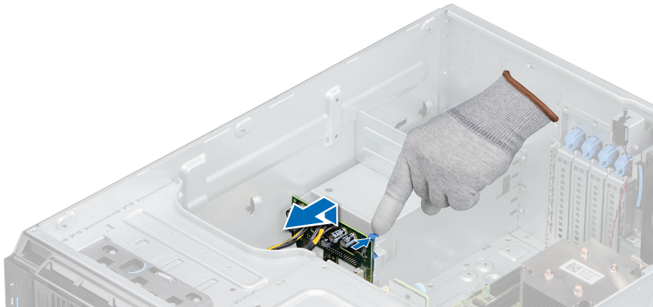
Ilustración 76. Extracción de la placa mediadora de alimentación
