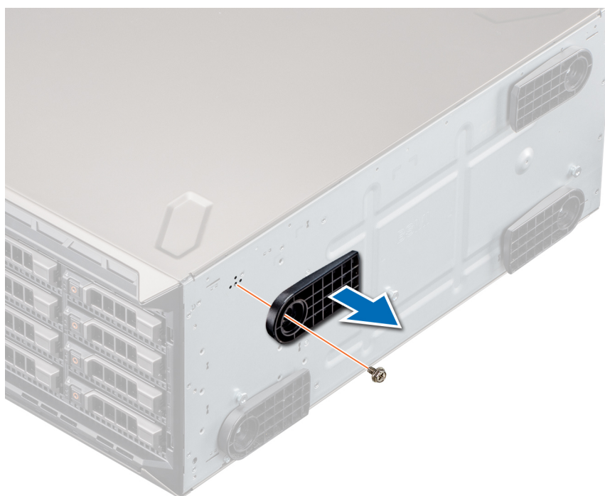
Ilustración 19. Extracción de los pies del sistema
