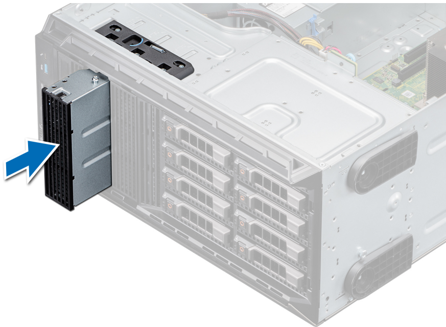
Ilustración 39. Instalación de la unidad óptica o de la unidad de cinta de relleno
