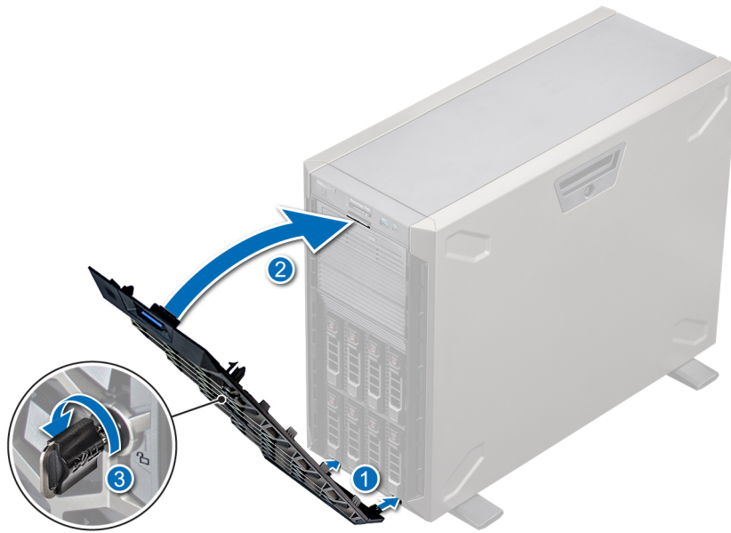
Ilustración 18. Instalación del bisel frontal
