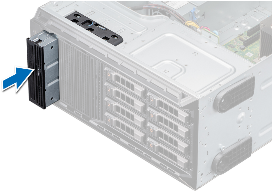
Ilustración 41. Instalación de la unidad óptica
