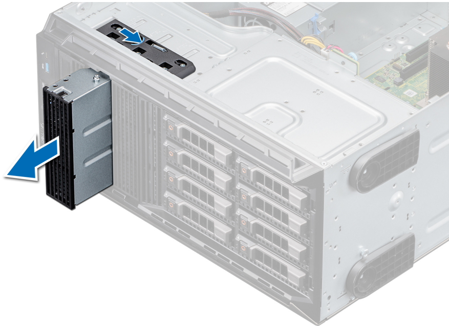
Ilustración 38. Extracción de la unidad óptica o de cinta de relleno
