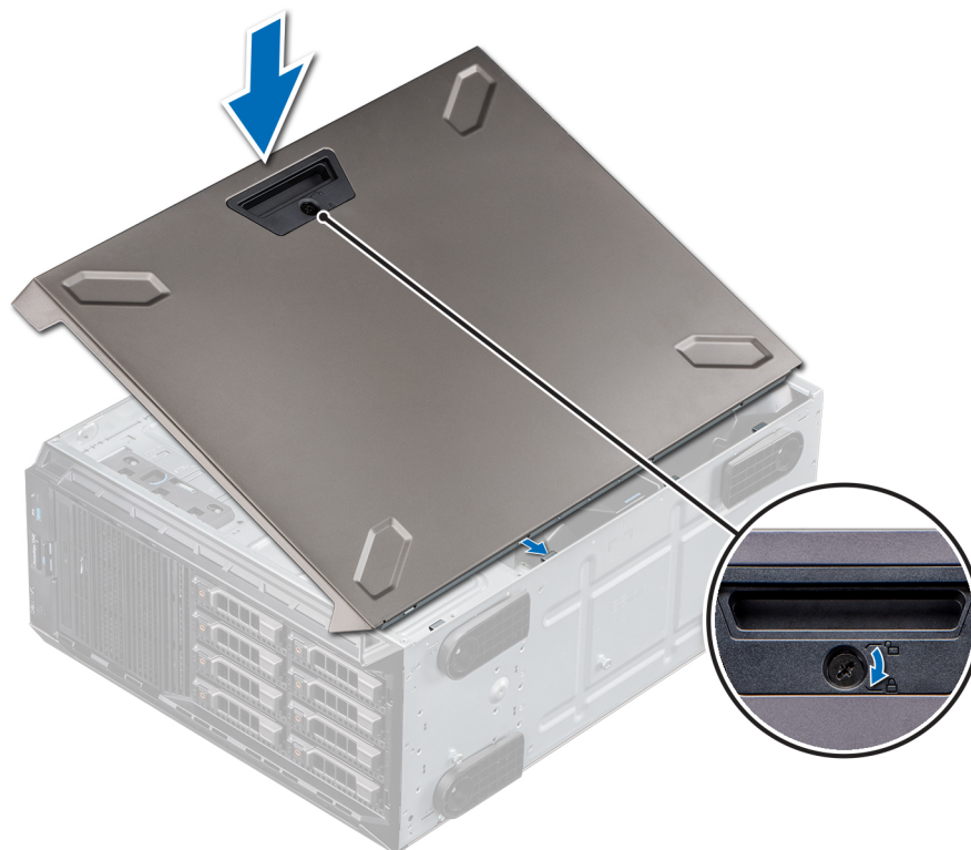
Ilustración 23. Instalación de la cubierta del sistema
