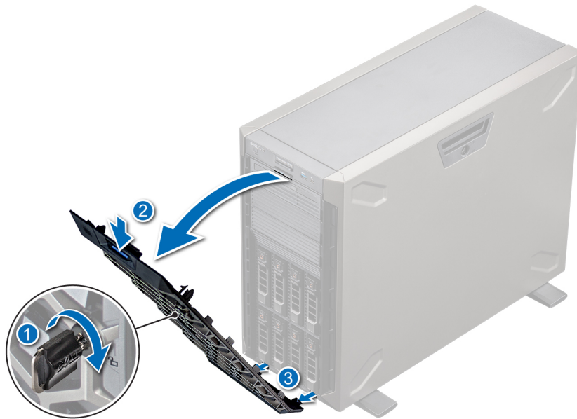
Ilustración 17. Extracción del bisel frontal
