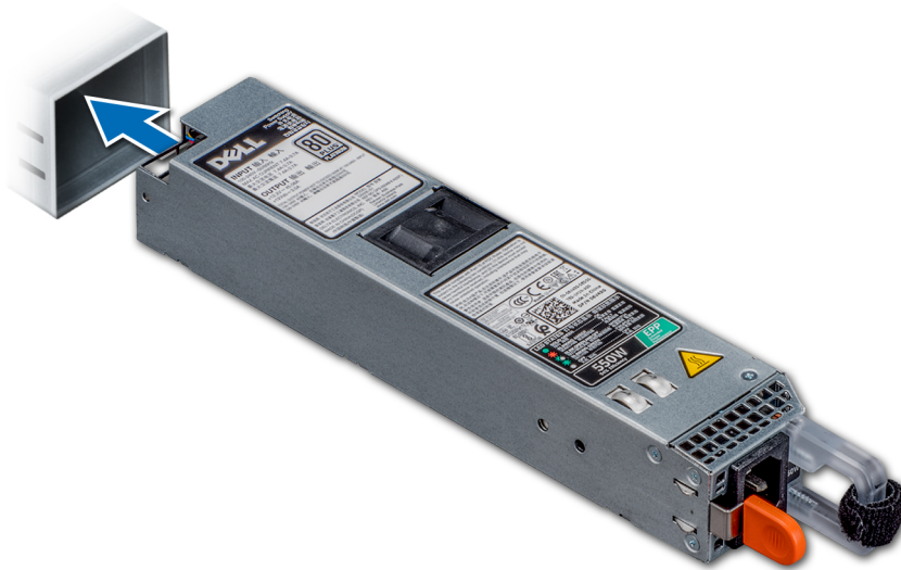
Ilustración 71. Instalación de una unidad de suministro de energía
