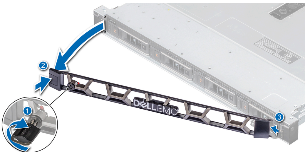
Ilustración 13. Extracción del bisel frontal opcional
