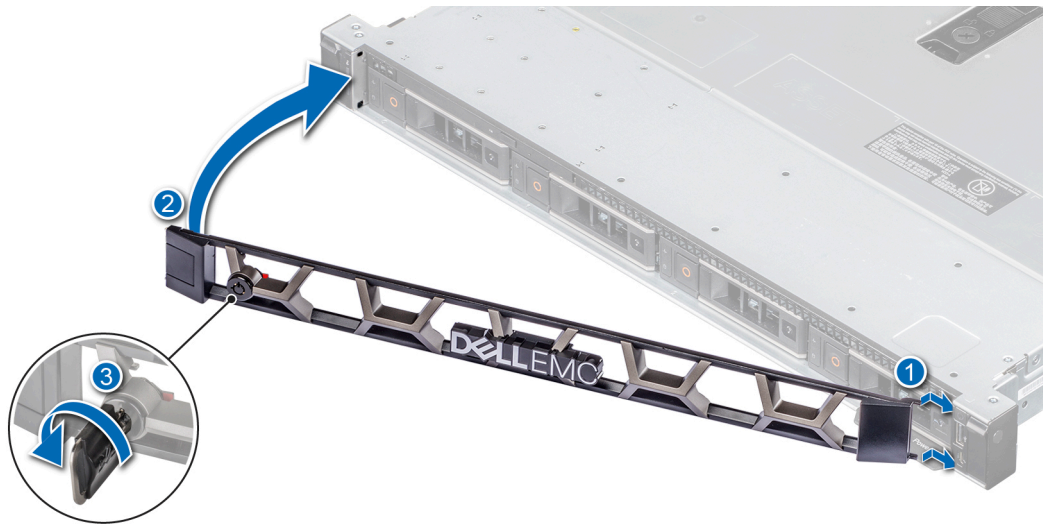
Ilustración 14. Instalación del bisel frontal opcional
