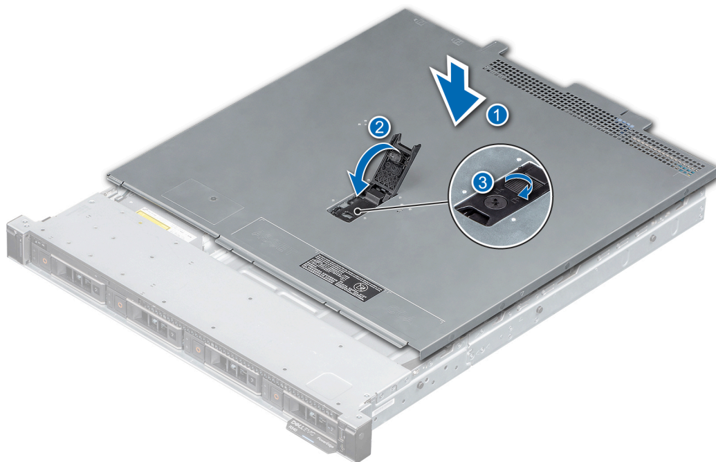
Ilustración 16. Instalación de la cubierta del sistema
