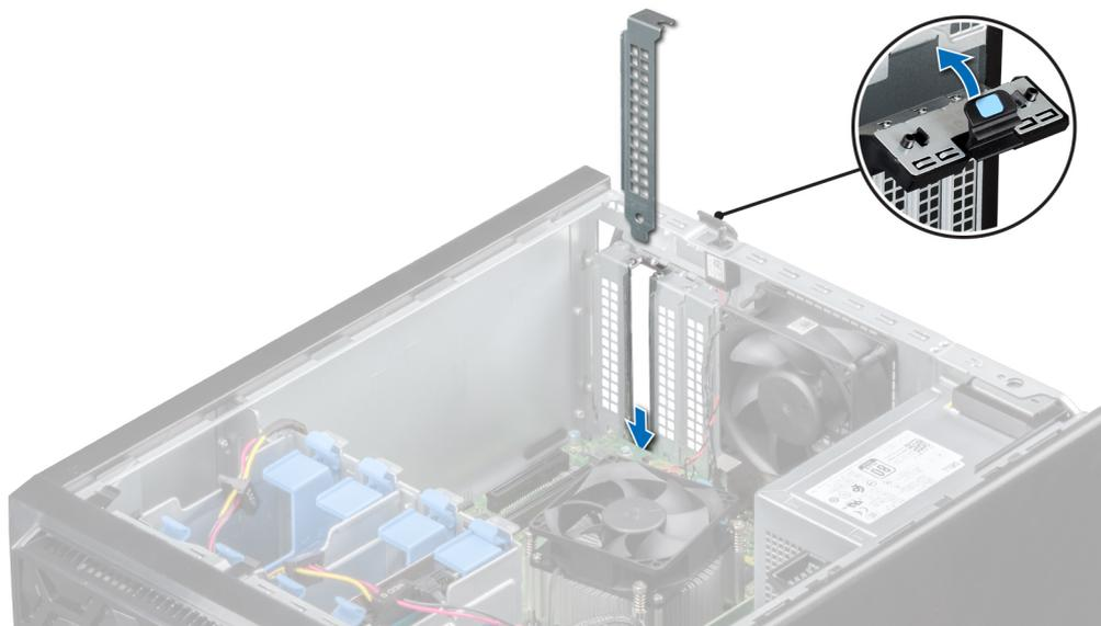
Figure 29. Installation de la plaque de recouvrement
