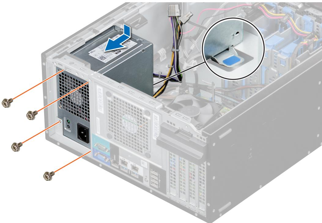
**Figure 45. Installation du bloc d'alimentation**
