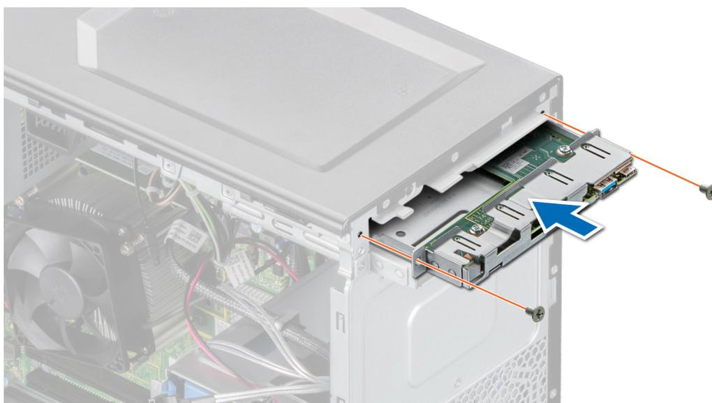
**Figure 57. Installation du bâti du panneau de commandes**
