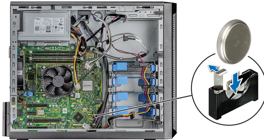
Figure 47. Installation de la batterie du système
