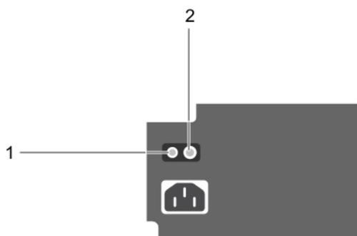
**Figure 62. Voyant d'état et bouton d'auto-diagnostic du bloc d'alimentation câblé en CA non redondant**
