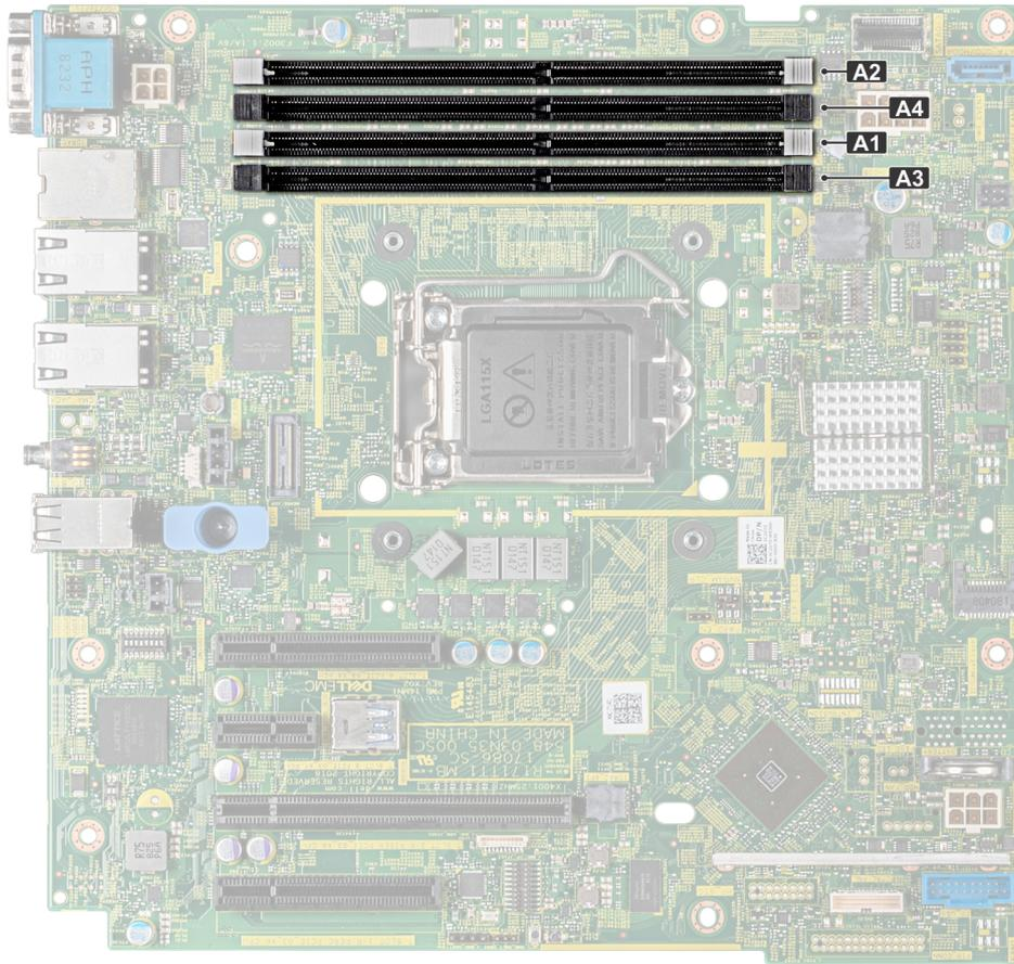
Figure 23. Emplacements des sockets de mémoire sur la carte système
