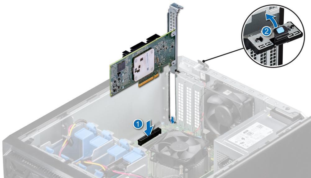
**Figure 33. Installation d'une carte contrôleur de stockage intégré**
