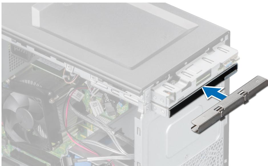
Figure 20. Installation de la plaque de recouvrement du lecteur optique dans le bâti du lecteur optique
