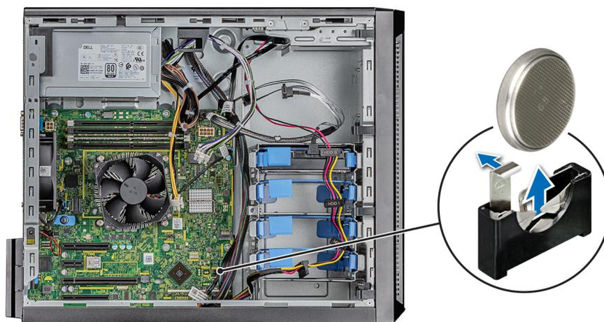
**Figure 46. Retrait de la pile du système**
