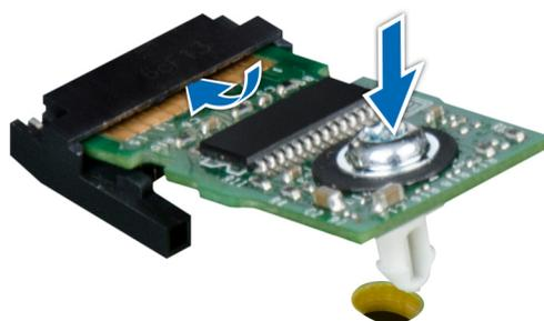
Figure 53. Installation du module TPM
