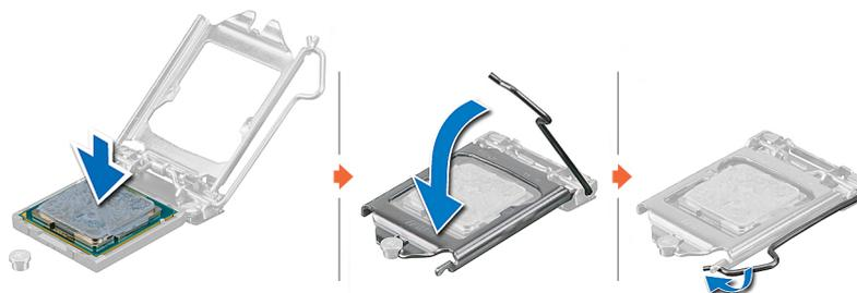
Figure 40. Installation du processeur
