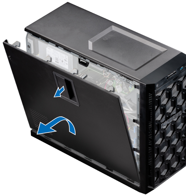
Ilustración 9. Extracción de la cubierta del sistema
