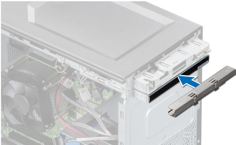
Ilustración 20. Instalación de la unidad óptica de relleno en la canastilla para unidad óptica
