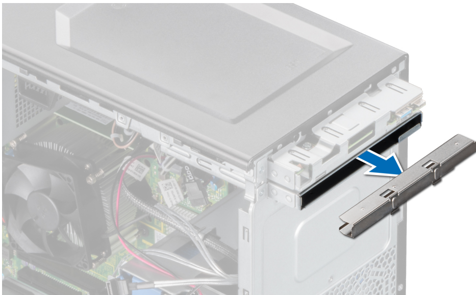
Ilustración 18. Extracción de la unidad óptica de relleno de la canastilla para unidad óptica
