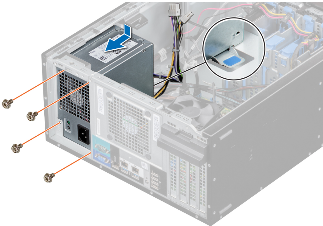
Ilustración 45. Instalación de la PSU
