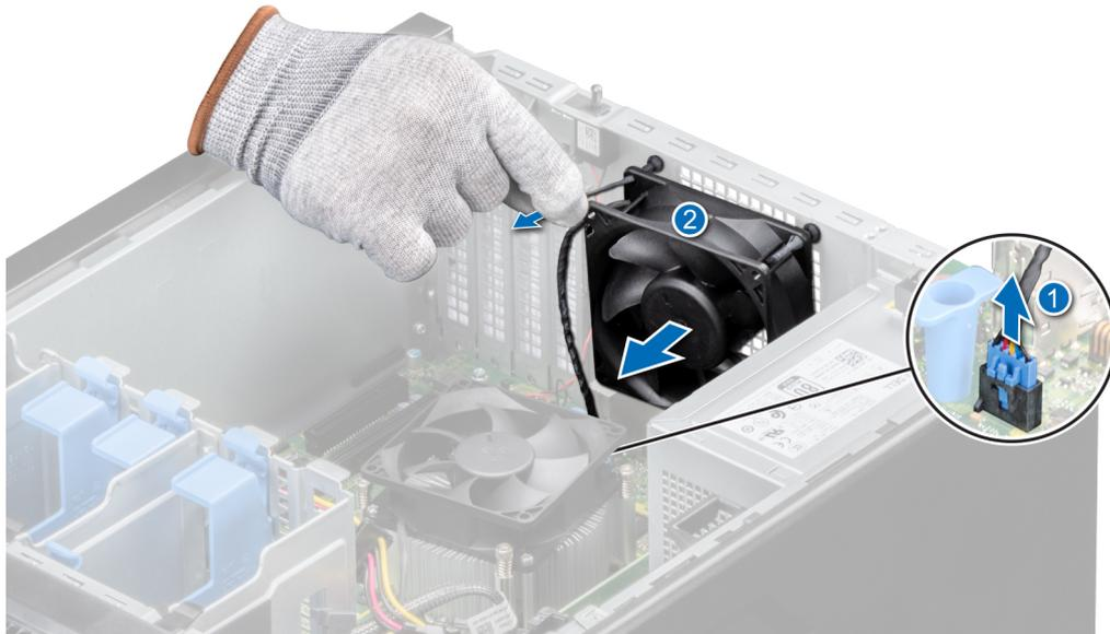
Abbildung 26. Entfernen des Kühlungsüfters
