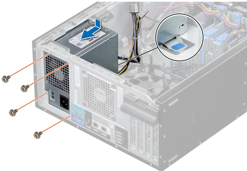
**Abbildung 45. Installieren des Netzteils**
