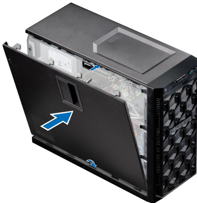
Abbildung 10. Installieren der Systemabdeckung
