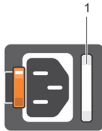
Ilustración 9. Indicador de estado de la unidad de fuente de alimentación de CA
