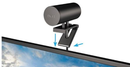
4. Presione la base del montaje de la webcam hacia la cubierta trasera del monitor para asegurarse de que la cámara está firmemente acoplada.
