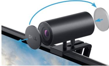
**NOTA:** Cuando la webcam está montada utilizando el montaje de webcam, puede inclinarse hacia arriba o hacia abajo según se prefiera.
