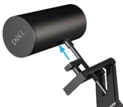
3. Abra la base de montaje de la webcam y sujételo junto con la webcam en el engaste del monitor.
