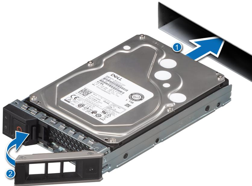
Abbildung 22. Einbauen des Hot-Swap-fähigen Laufwerks
