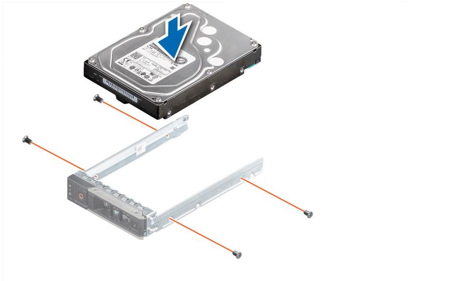
Abbildung 24. Einsetzen eines Laufwerks in den Laufwerksträger
