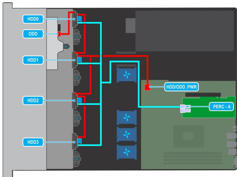
Abbildung 65. Kabelführung – 4 verkabelte 3,5-Zoll-Laufwerke mit PERC
