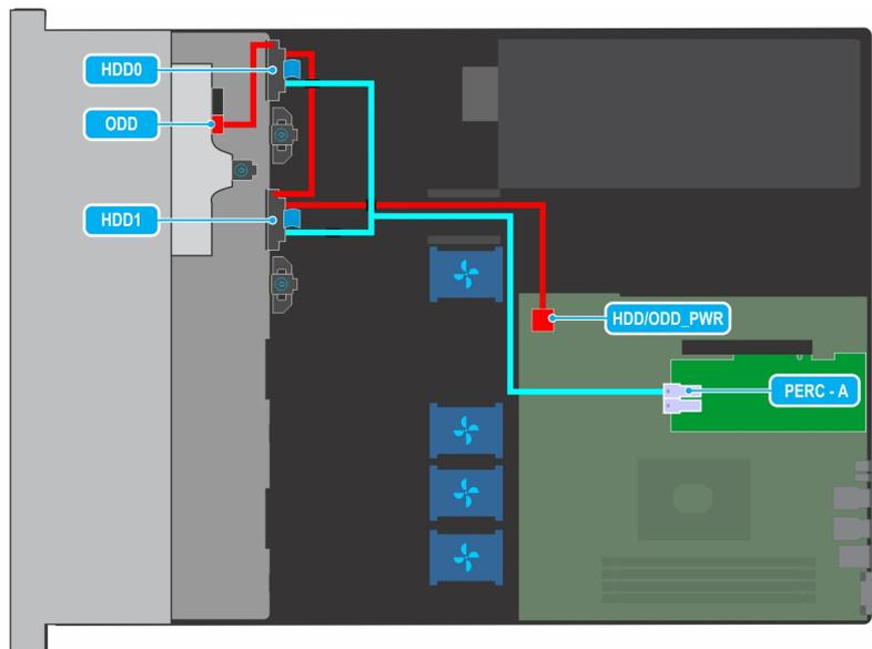
Abbildung 67. Kabelführung – 2 verkabelte 3,5-Zoll-Laufwerke mit PERC
