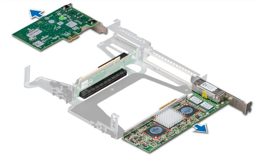
**Abbildung 43. Entfernen einer Erweiterungskarte aus dem Erweiterungskarten-Riser**
