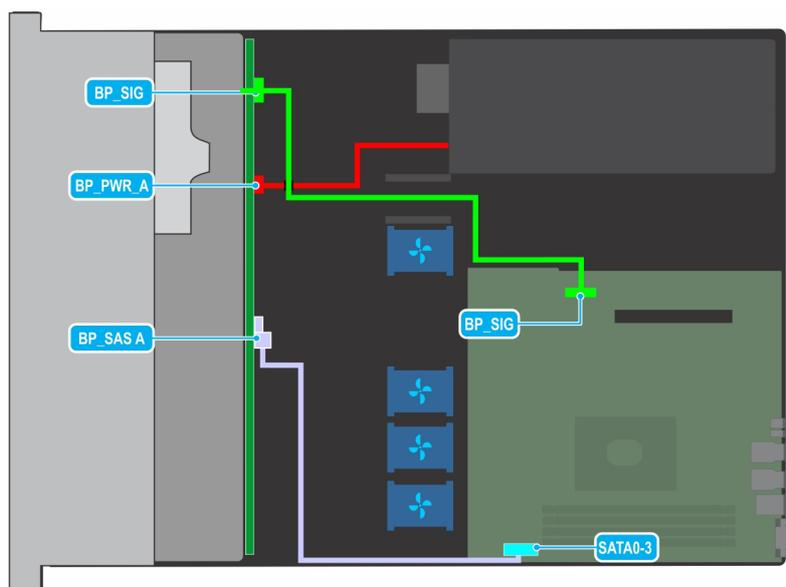
Abbildung 64. Kabelführung – 4 x 3,5-Zoll-Laufwerksrückwandplatine mit SATA
