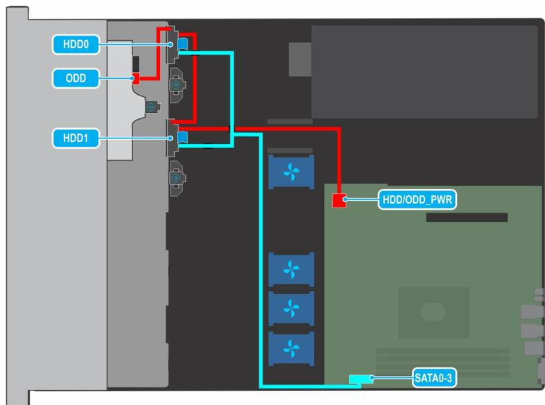
Abbildung 68. Kabelführung – 2 verkabelte 3,5-Zoll-Laufwerke mit SATA
