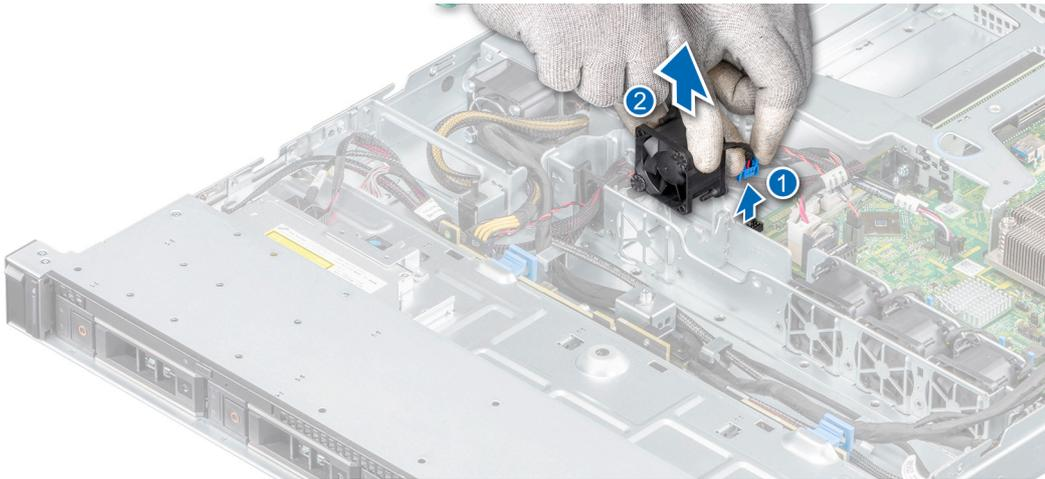
Abbildung 17. Entfernen eines Kühlungslüfters
