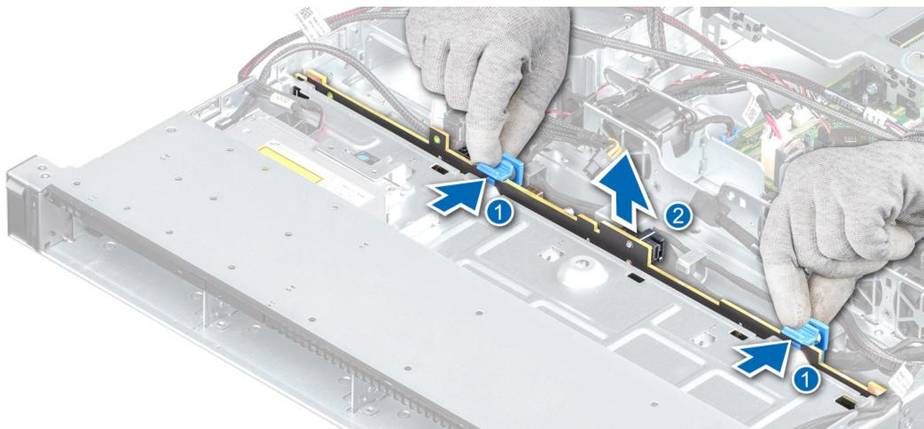
Abbildung 61. Laufwerkrückwandplatine entfernen
