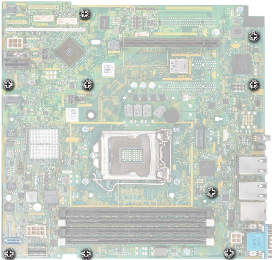
**Abbildung 71. Schrauben, mit denen die Hauptplatine befestigt ist**
