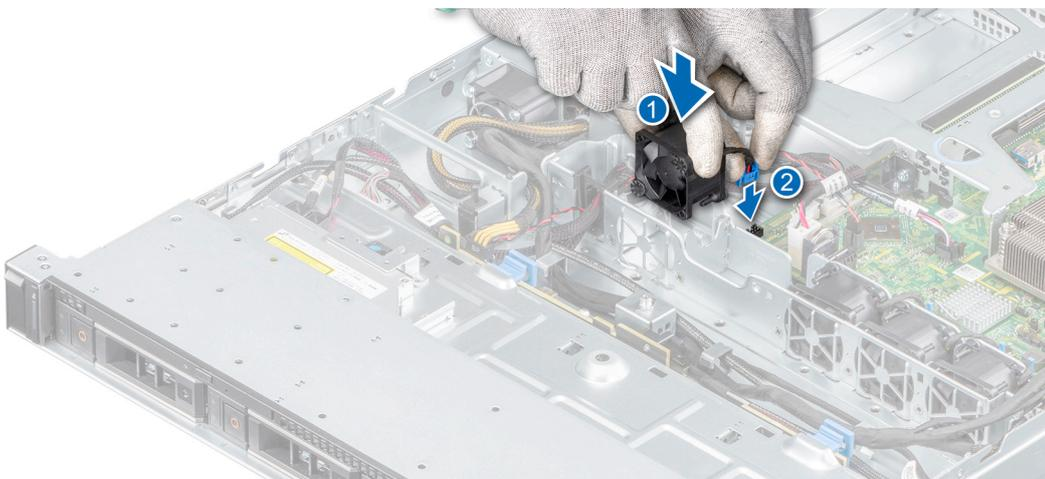
Abbildung 18. Einbauen eines Lüfters
