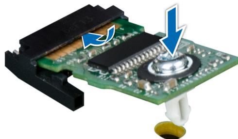
Abbildung 74. Installieren des TPM-Moduls
