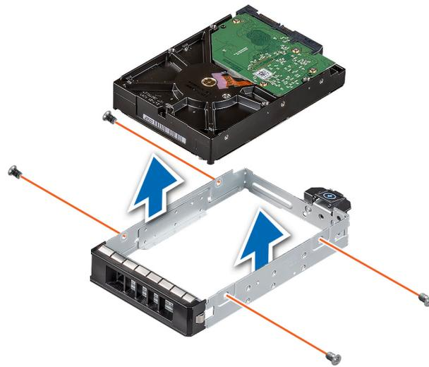
Abbildung 31. Entfernen des verkabelten Laufwerks aus dem Laufwerksträger
