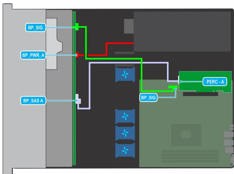
Abbildung 63. Kabelführung – 4 x 3,5-Zoll-Laufwerksrückwandplatine mit PERC
