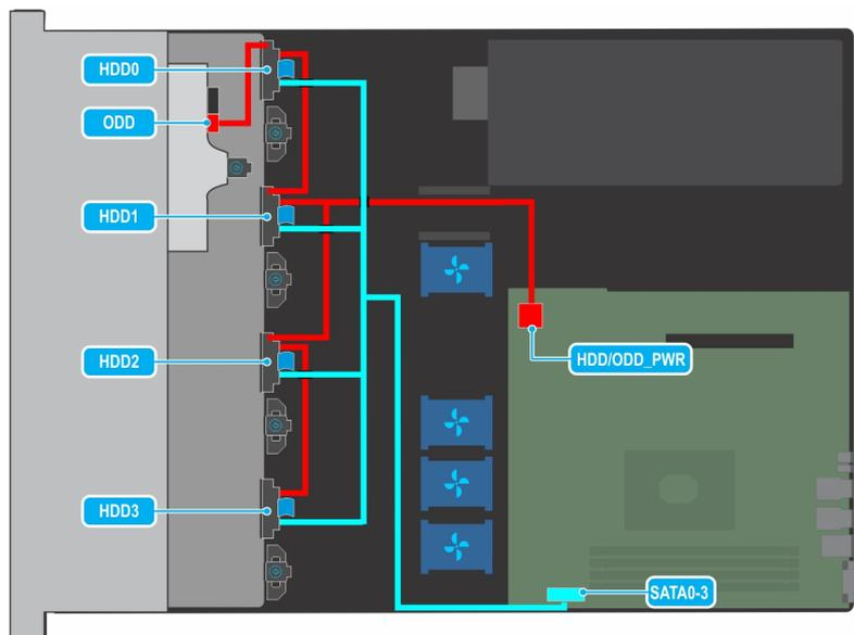
Abbildung 66. Kabelführung – 4 verkabelte 3,5-Zoll-Laufwerke mit SATA
