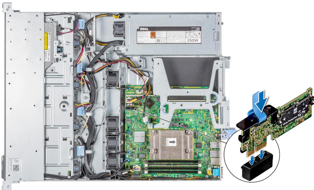
Abbildung 57. Installieren der optionalen IDSDM- oder vFlash-Karte.
