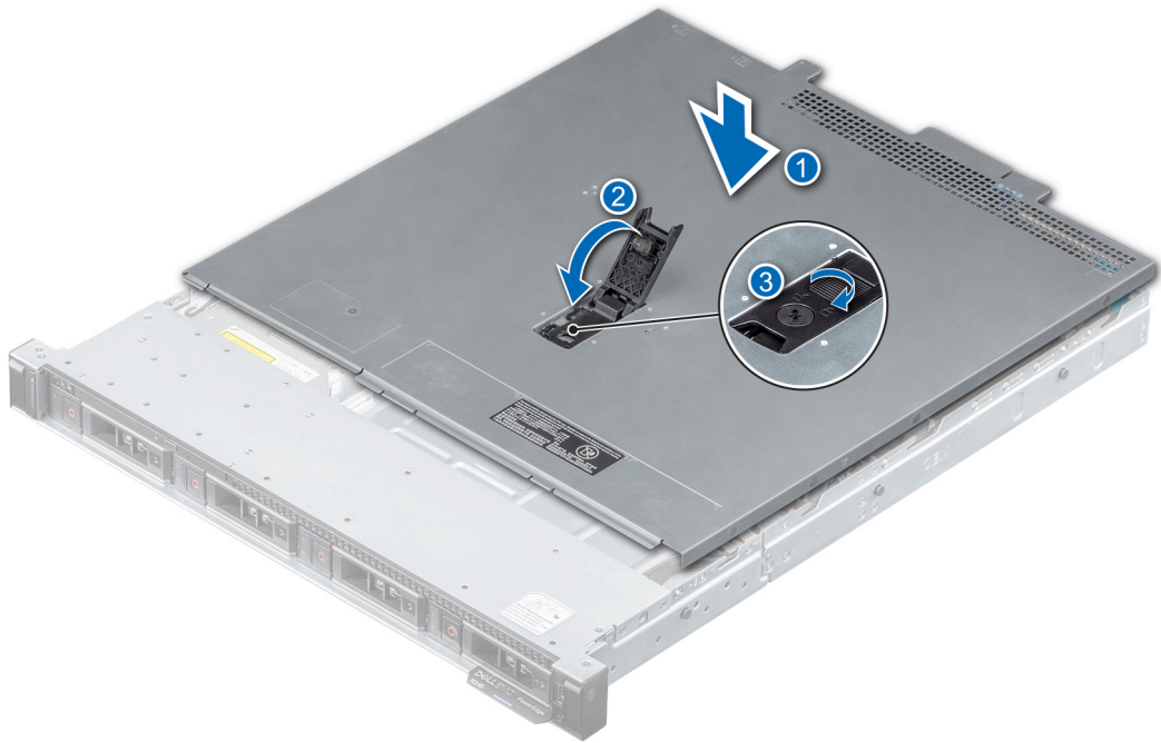
Ilustración 12. Instalación de la cubierta del sistema
