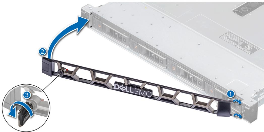
Figure 10. Installation du panneau avant
