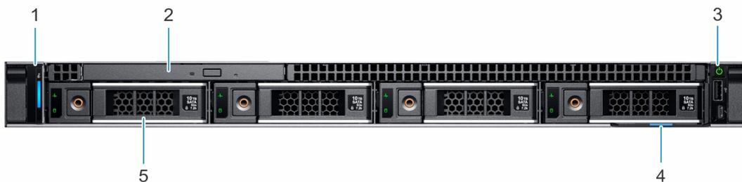
**Figure 1. Vue avant d'un système de 4 disques de 3,5 pouces**
