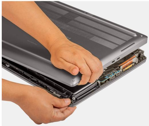
3. Heben Sie die Bodenabdeckung vom unteren Rand aus an und entfernen Sie sie nach hinten hin vom Computer.
