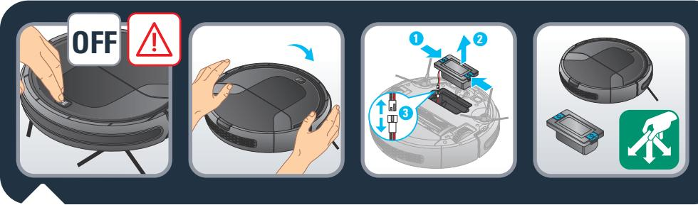
**FR** Attention : Avant d'enlever la batterie, mettez le robot hors tension. Retournez le robot à l'envers pour accéder au compartiment de la batterie. Retirez la batterie en appuyant sur les loquets du compartiment de la batterie et retirez la batterie. Déconnectez la batterie du robot. Recyclez la batterie et le robot.
