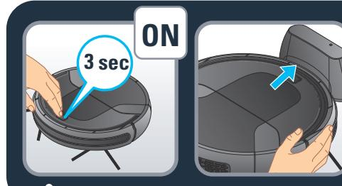
**FR** Pour charger le robot, allumez-le en appuyant sur le bouton marche / arrêt pendant 3 secondes. Placez le robot sur la station d'accueil : les plaques de charge du robot doivent toucher celles de la station d'accueil.
