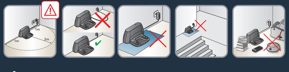
**FR** Pour placer la base de charge, assurez-vous qu'il y a un espace vide de 1 m sur le côté et 2 m en face de la base de charge. N'installez pas la base de charge près d'un escalier. Le câble doit être serré. Placez toujours la station d'accueil sur un sol dur. Ne placez pas la base de charge sur un tapis.
