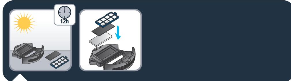
**FR** Laissez toutes les pièces sécher environ 12 heures. N'utilisez pas les filtres ni le bac à poussière s'il sont encore humides. Une fois secs, remettez les filtres dans le bac à poussière.
