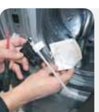
Vervang het deurslot en let op de mechanische koppeling van de nooddopopening en elektrische aansluitingen
