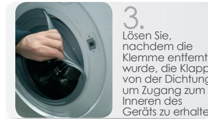
Lösen Sie, nachdem die Klemme entfernt wurde, die Klappe von der Dichtung, um Zugang zum Inneren des Geräts zu erhalten
