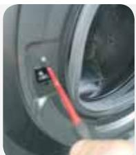
Gebruik een Torx-sleutel om de borgschroeven van het deurslot te verwijderen
