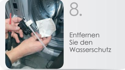
Entfernen Sie den Wasserschutz
