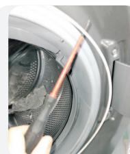
Use el destornillador plano como palanca y retire la abrazadera externa
