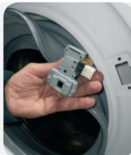
Desconecte el cableado, en caso de conexiones "faston", preste atención y no invierta el cableado
