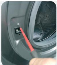
4. Utilizzare il cacciavite Torx per rimuovere le viti che tengono fissata la chiusura di sicurezza dello sportello
