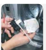
9. Înlocuiți sistemul de închidere a ușii având grijă la conectarea mecanică a deschiderii de urgență și a conexiunilor electrice
