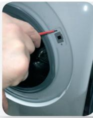
4. Χρησιμοποιώντας μηχανικό κλειδί τύπου Torx, αφαιρέστε τις βίδες στερέωσης της ασφάλειας πόρτας και πίστε την πόρτη.
