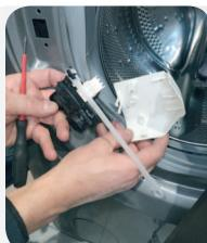
Vuelva a colocar el seguro de la puerta prestando atención a la conexión mecánica de la apertura de emergencia y las conexiones eléctricas
