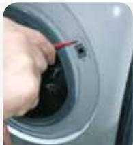
4. Cu ajutorul cheii Torx, scoateți șuruburile de fixare ale sistemului de închidere a ușii și apăsați încluiearea.
