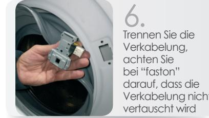
Trennen Sie die Verkabelung, achten Sie bei "faston" darauf, dass die Verkabelung nicht vertauscht wird
