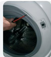
2. Χρησιμοποιήστε το επιπέδο κατσαβίδι ως μοχλό για να αφαιρέσετε τον εξωτερικό σφιγκτήρα
