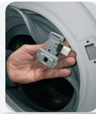
6. Disconnettere il cablaggio; in caso di connettore faston, prestare attenzione a non invertire il cablaggio
