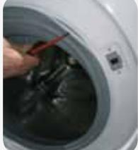
2. Folosiți șurubelnita cu cap plat pentru a ridica și a scoate clema externă
