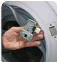
6. Deconectați cablajul, dacă există un „conector”, aveți grijă să nu inversați firele
