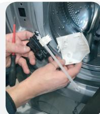
9. Sostituire la chiusura di sicurezza dello sportello facendo attenzione al collegamento meccanico dell'apertura di sicurezza e ai connettori elettrici
