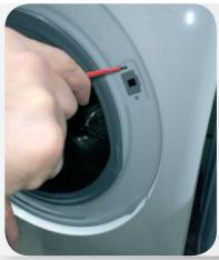
4. Utilizzare il cacciavite Torx per rimuovere le viti che tengono fissata la chiusura di sicurezza dello sportello e premere sul suo fermo.
