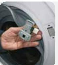
Ontkoppel de bedrading, in het geval van "faston", let op dat u de bedrading niet omkeert
