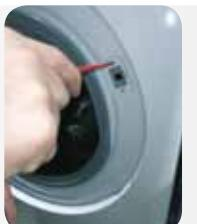
Gebruik een Torx-sleutel, verwijder de bevestigingsschroeven van het deurslot en druk op de sluiting.
