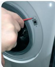
Con la llave Torx retire los tornillos de sujeción del seguro de la puerta y presione el broche.
