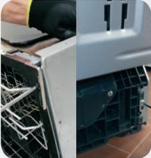
2. Χρησιμοποιώντας το μηχανικό κλειδί για σωλήνες αριθ. 15, αφαιρέστε τις βίδες που στερεώνουν το κάλυμμα του θαλάμου
