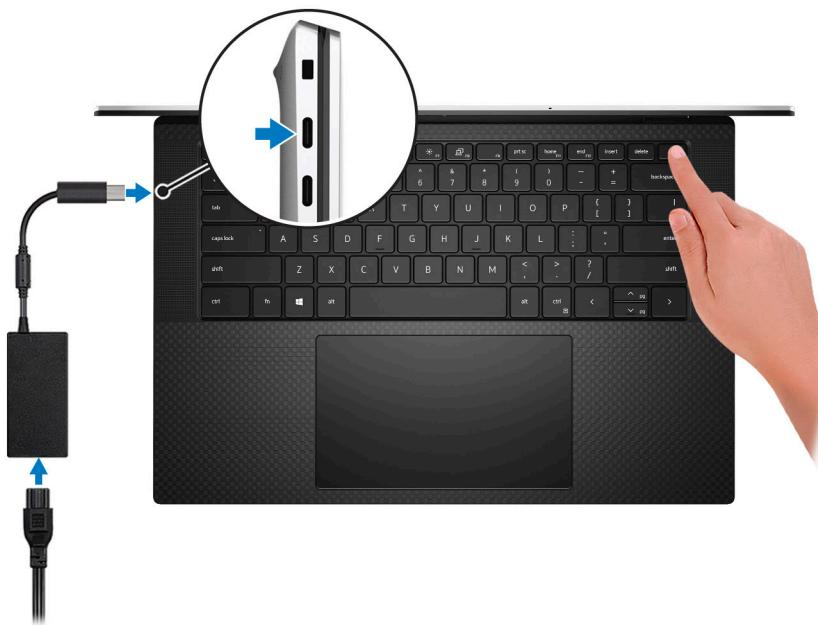
**i | N.B.:** È possibile caricare il sistema collegando l'adattatore di alimentazione a una delle porte Thunderbolt 4 (USB Type-C) che si trovano sul lato sinistro del computer o alla porta USB 3.2 Gen 2 (Type-C) che si trova sul lato destro del computer.
