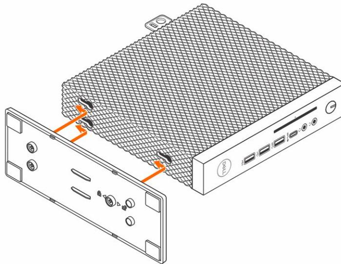
**Abbildung 2. Montieren des Standrahmens**
