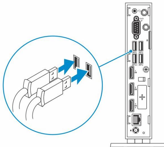
**Abbildung 3. Installieren von Tastatur und Maus**
