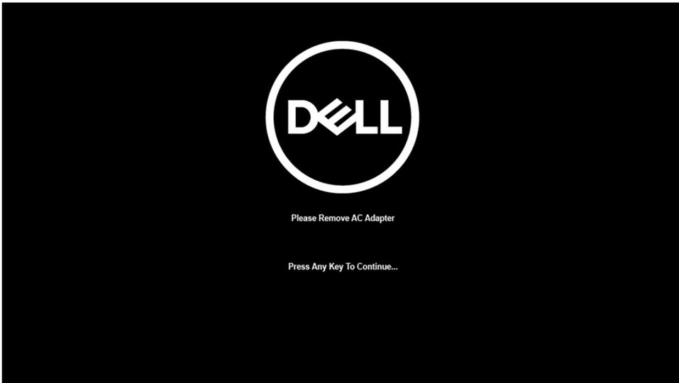
5. Cuando el mensaje listo para continuar aparezca en la pantalla, presione cualquier tecla para continuar. El sistema emitirá tres pitidos cortos y se apaga de inmediato.
