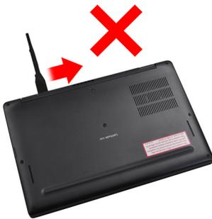
3. Haga palanca para abrir los laterales izquierdo y derecho de la cubierta de la base.
