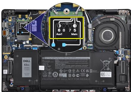
2. Afloje el tornillo (M2x2.5) y quite el soporte de la tarjeta WWAN.
