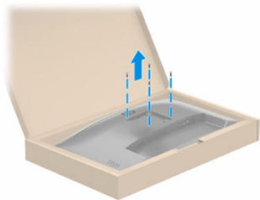
2. Per fissare la testa del monitor a un braccio snodabile o ad altri dispositivi di montaggio, inserire quattro viti di montaggio nei fori sul dispositivo di montaggio e nei fori per le viti VESA sul retro della testa del monitor.
