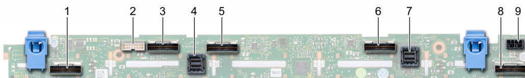
Figure 35. Fond de panier pour 10 disques SAS, SATA ou NVMe de 2,5 pouces
