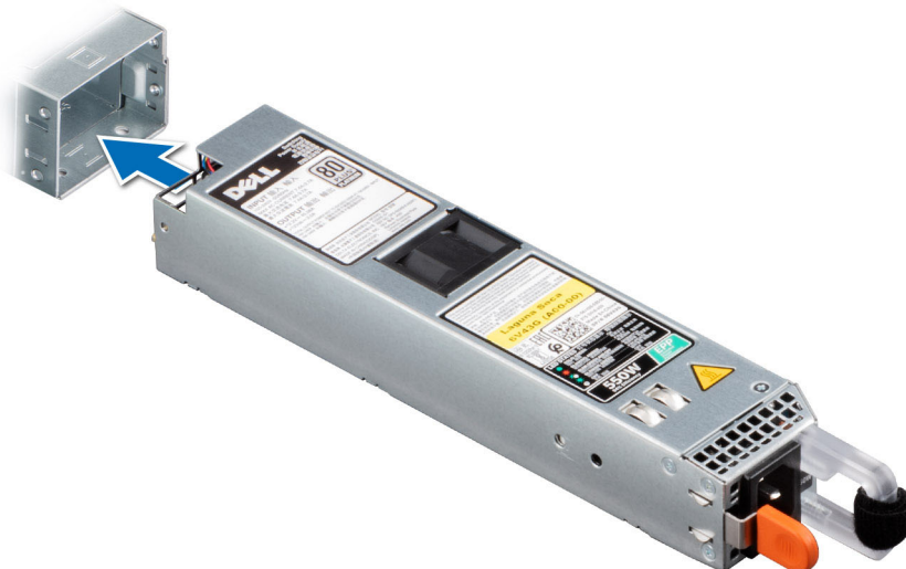
Figure 92. Installation d'un bloc d'alimentation
