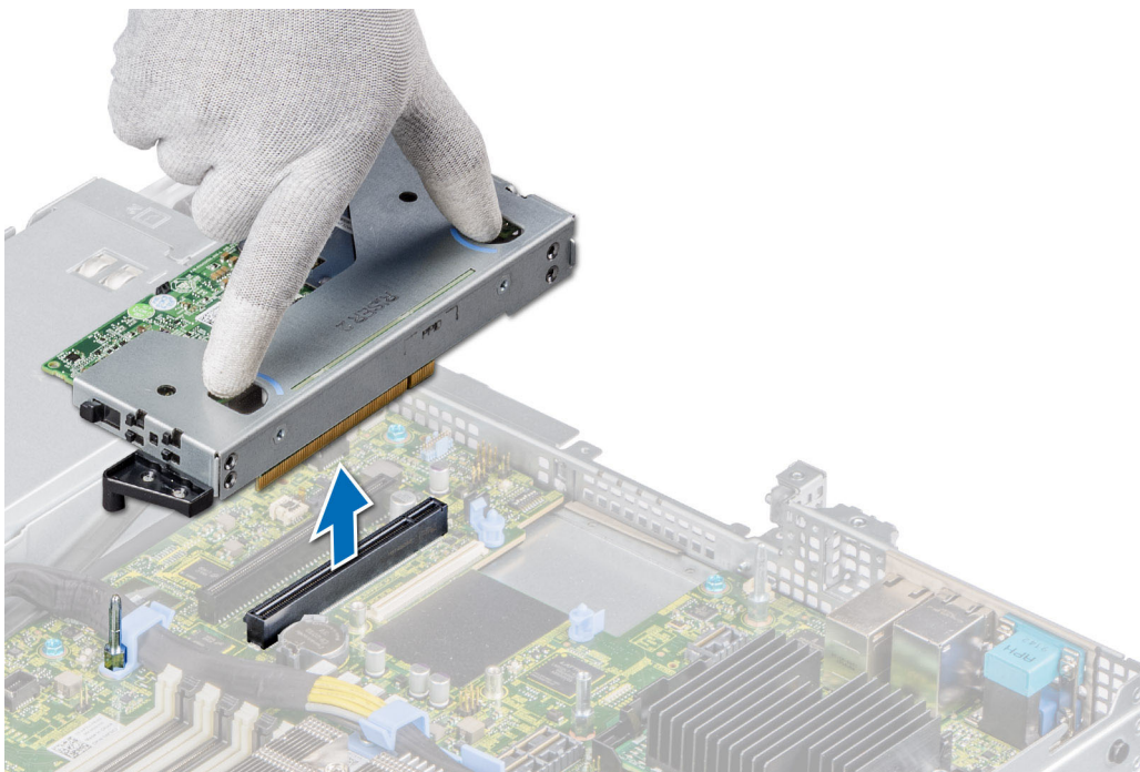
Figure 54. Retrait de la carte de montage mi-hauteur gauche
