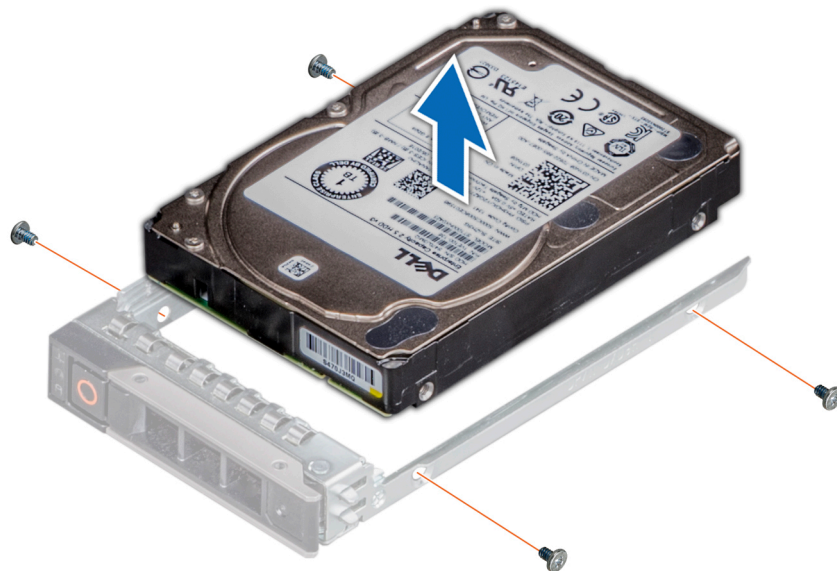
Figure 31. Retrait d'un disque dur installé de son support
