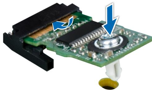
Figure 128. Installation du module TPM
