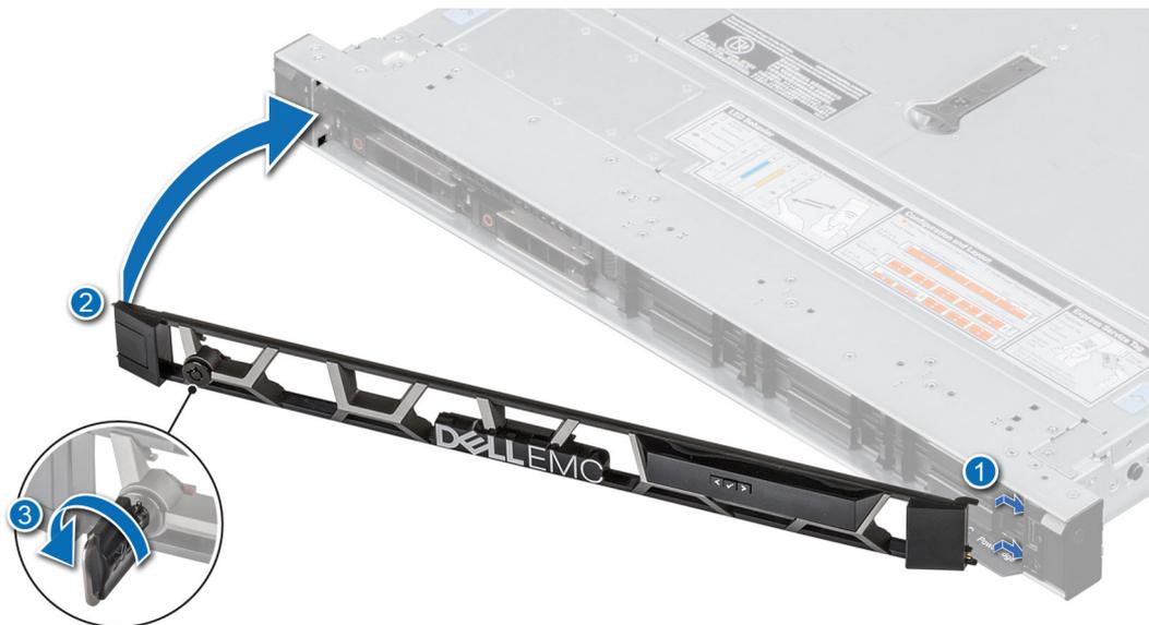
Figure 16. Installation du panneau avant
