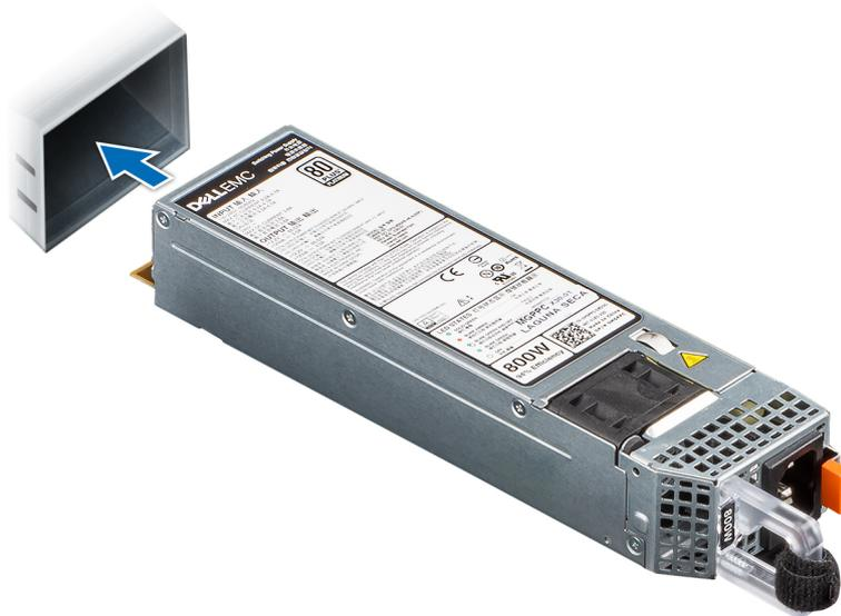
Figure 127. Installation d'un bloc d'alimentation
