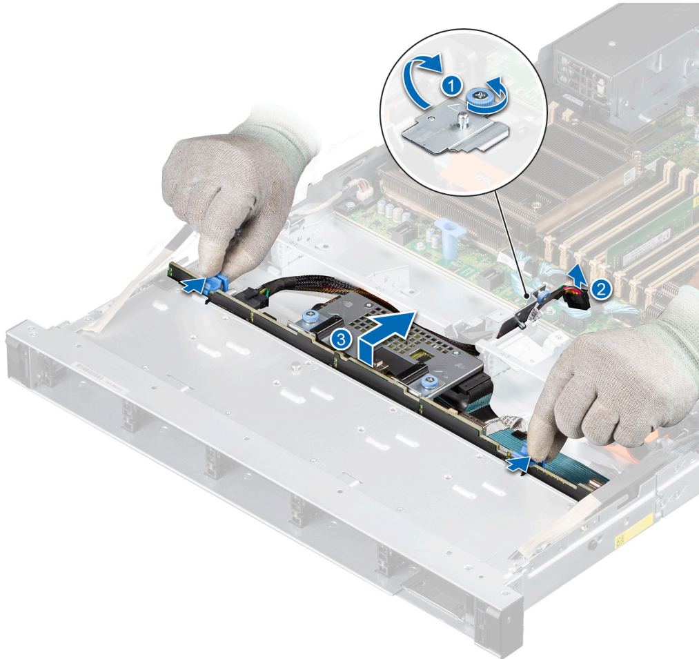
Abbildung 42. Laufwerkrückwandplatine entfernen
